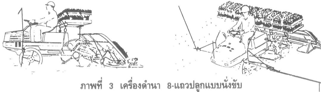
ภาพที่ 3 เครื่องดำเนา 8-แควปลูกแบบนั่งขับ
