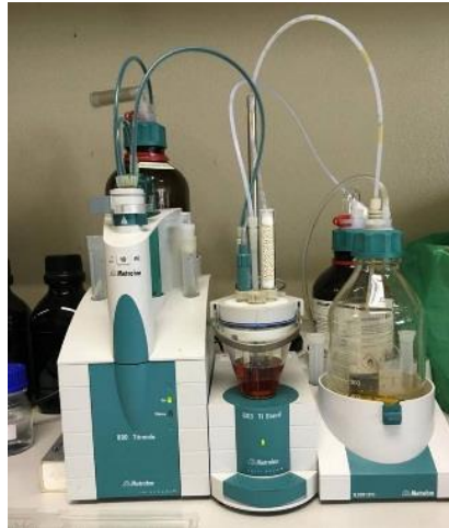
รูปที่ 15. เครื่องวิเคราะห์หาปริมาณน้ำด้วยวิธี Karl Fischer.
