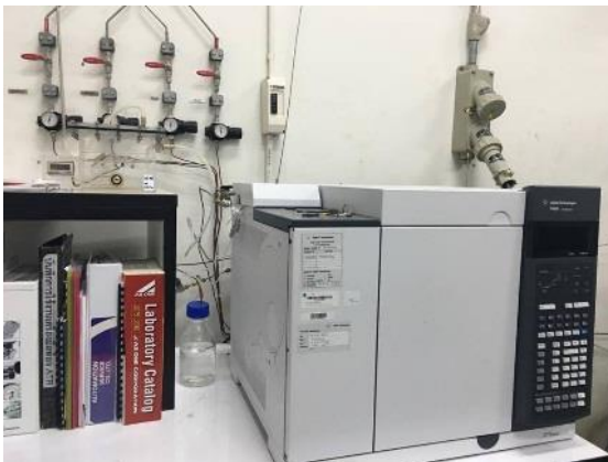
รูปที่ 13. เครื่องก๊าซโครมาโทกราฟีสำหรับวิเคราะห์ตัวอย่างที่เป็นก๊าซ.
