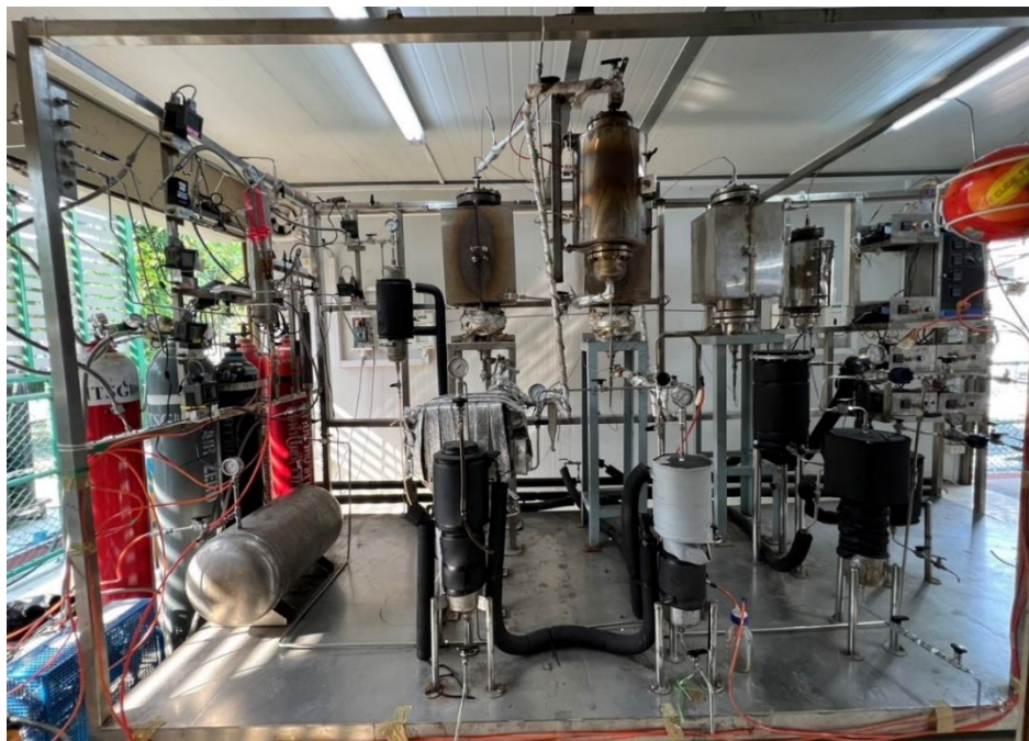
รูปที่ 11. ปฏิกรณ์แบบเบตนิ่ง (Fixed-bed reactor) ระดับห้องปฏิบัติการ ที่ใช้สำหรับผลิตเมทานอลจากก๊าซสังเคราะห์.
