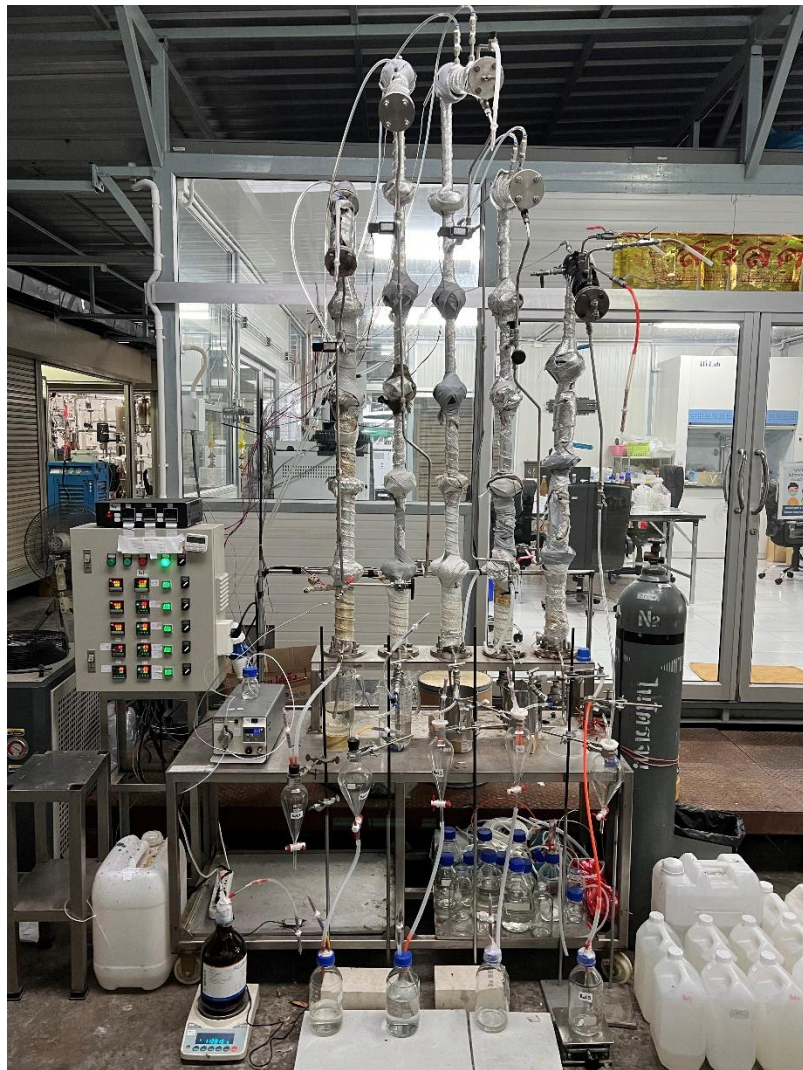
รูปที่ 12. เครื่องกลั่นลำดับส่วนแบบ 5 หอ ต่อเนื่องที่ติดตั้งระบบรีฟลักซ์อัตโนมัติ ระดับห้องปฏิบัติการที่ใช้สำหรับการเพิ่มความบริสุทธิ์ไบโอเมทานอล.
