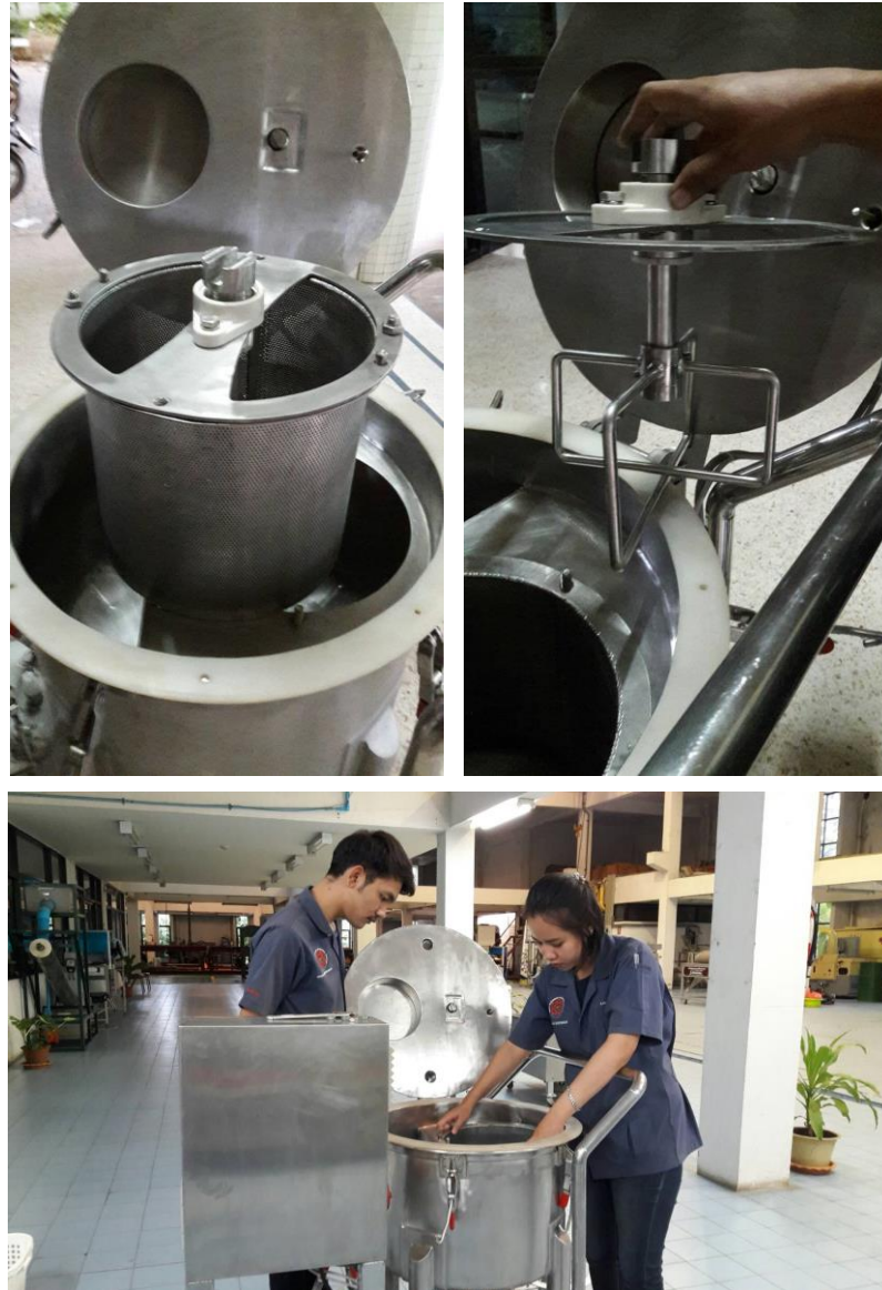
รูปที่ 32. ตะแกรงและใบกวนที่ถอดประกอบได้ในถังหมัก.
