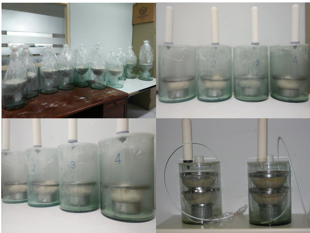
รูปที่ 18. การทดลองขยายขนาดปริมาณการผลิตน้ำตาลจากข้าวแบบแยกน้ำตาลข้าวจากผลของความเหมาะสมตามสถิติโมเดล RSM.
