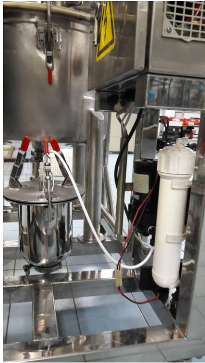
รูปที่ 33. อุปกรณ์เมมเบรนในการนำเอนไซม์กลับมาใช้ซ้ำ และเซรามิคเมมเบรนขนาด 0.3 ไมครอน สำหรับกรองอากาศให้ปลอดภัย.
