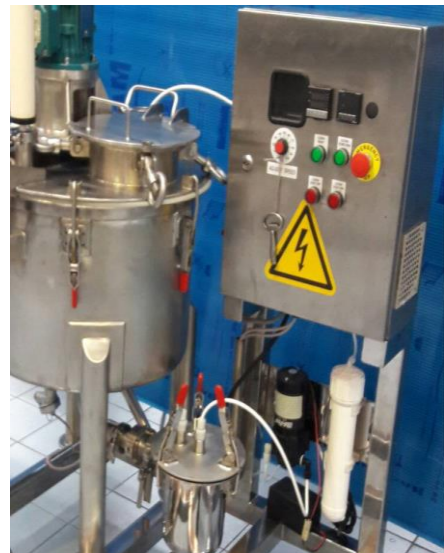
รูปที่ 34. ระบบควบคุมอุณหภูมิที่ประกอบอยู่ใต้ตัวถัง และระบบควบคุมความชื้นที่ประกอบอยู่บนตัวถัง.
