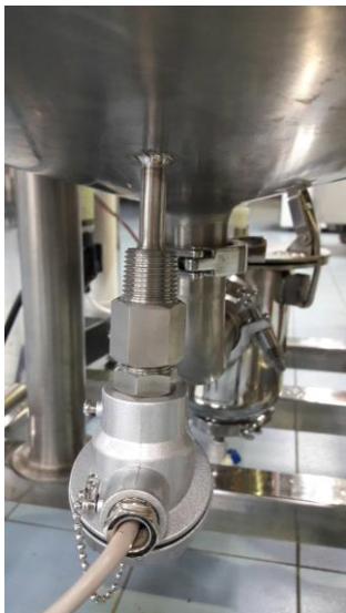
รูปที่ 34. ระบบควบคุมอุณหภูมิที่ประกอบอยู่ใต้ตัวถัง และระบบควบคุมความชื้นที่ประกอบอยู่บนตัวถัง.
