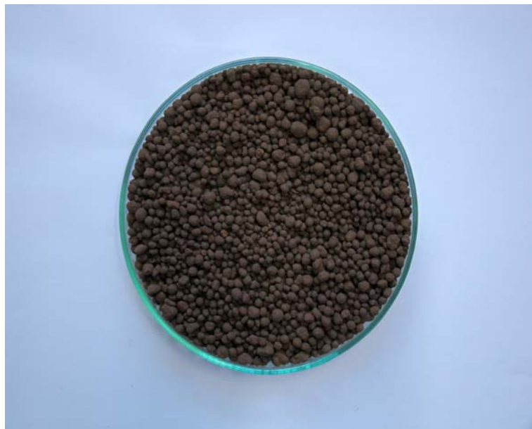
รูปที่ 1. ผลิตภัณฑ์ปรับปรุงดินจากสาหร่ายแบบเม็ดขนาดเส้นผ่าศูนย์กลาง 0.5-2.0 มิลลิเมตร ที่มีความเข้มข้นของสาหร่าย 10^8 CFU ต่อกรัม.
