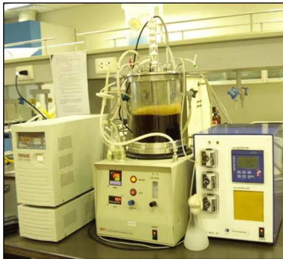
รูปที่ 8. ถังหมักขนาด 5 ลิตร ในการเลี้ยงยีสต์โดยใช้กากน้ำตาลเป็นวัตถุดิบ.
