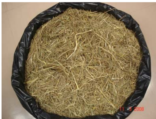
รูปที่ 3.3. ฟางข้าวหลังบดด้วยเครื่องสับผักตบชวา.
