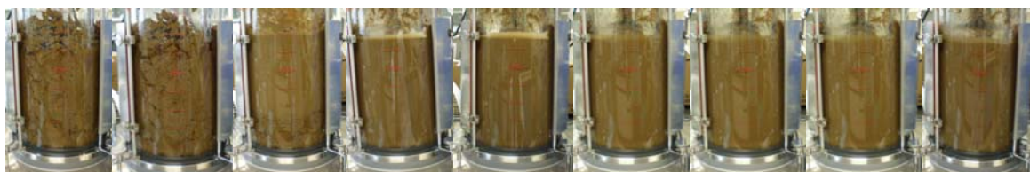
รูปที่ 3.32. การเปลี่ยนแปลงทางกายภาพของฟางข้าวที่เตรียมด้วย 1.00%(w/v)H 2 SO 4 , 121°ซ., 15 นาที และไฮโดรไลซิสด้วยเอนไซม์ (Accellerase 1000™) ปริมาณ 45 FPU/g Dry residue substrate ที่พีเอช 5.0 อุณหภูมิ 50°ซ. อัตราการกวน 160 รอบต่อนาที.
