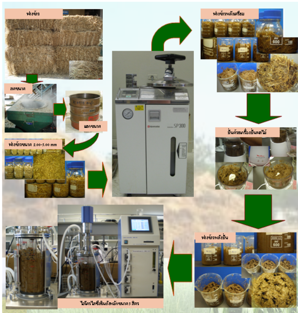
รูปที่ 3.31. ขั้นตอนในการผลิตน้ำตาลจากฟางข้าว ด้วยการไฮโดรไลซิสด้วยเอนไซม์ในระดับถังหมักขนาด 5000 มิลลิลิตร.
