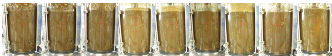
รูปที่ 3.33. การเปลี่ยนแปลงทางกายภาพของฟางข้าวที่เตรียมด้วย 3.00%(w/v)H 2 SO 4 , 121°ซ., 30 นาที และไฮโดรไลซิสด้วยเอนไซม์ (Accellerase 1000™) ปริมาณ 45 FPU/g Dry residue substrate ที่พีเอช 5.0 อุณหภูมิ 50°ซ. อัตราการกวน 160 รอบต่อนาที.
