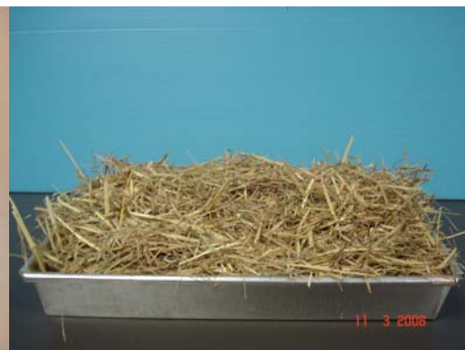
รูปที่ 3.3. ฟางข้าวหลังบดด้วยเครื่องสับผักตบชวา.
