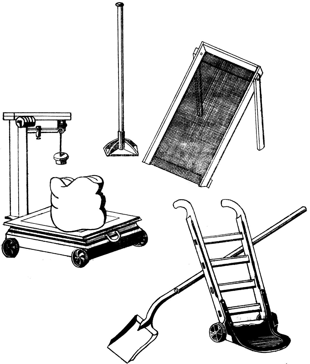
เครื่องมือที่ควรมีไว้ใช้ผสมปุ๋ยสำหรับไร่นาขนาดใหญ่
