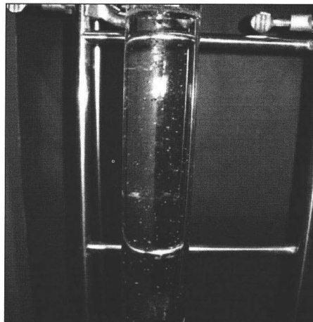
รูปที่ 4 ในคอลัมน์ที่ 1 - 3 เมื่อเทปรอทลงสู่คอลัมน์ ปรอทกระจายตัวเป็นเม็ดเล็กๆ ตกลงสู่คอลัมน์ที่มีกรดไนตริกมีความเข้มข้น 2M, 1.5M และ 1M ตามลำดับ ในคอลัมน์ที่ 4 - 5 เช่นเดียวกับคอลัมน์ที่ 1-3 ปรอทกระจายตัวเป็นเม็ดเล็กๆ ตกลงสู่คอลัมน์ แต่ภายในคอลัมน์ที่ 4 - 5 บรรจุน้ำ เพื่อสกัดกรดไนตริกออกจากปรอท
