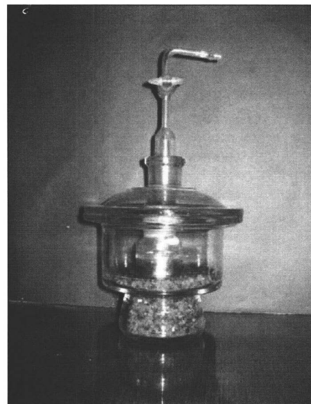
รูปที่ 10 นำปรอทที่บริสุทธิ์เก็บไว้ในเดซิคเคเตอร์ บรรจุซิลิกาเจลอยู่ข้างล่าง เพื่อดูความชื้น เก็บไว้ใช้ทำการทดลองครั้งต่อไป
