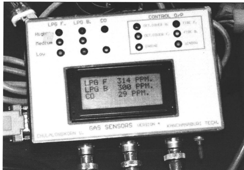
รูปที่ 2 เครื่องเตือนและป้องกันภัยแก๊สรั่วไหลในรถยนต์ต้นแบบที่พัฒนาขึ้น
