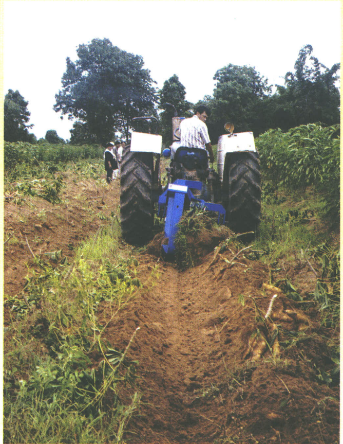
▲ เครื่องชุดหัวมันสำปะหลัง ใช้ติดท้ายรถแทรกเตอร์ ▲
