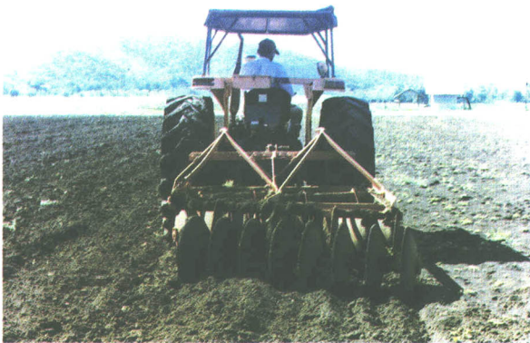
▲ การเตรียมดิน : ไถด้วยพาสสาม แล้วพรวนด้วยพาสเจ็ด ▼
