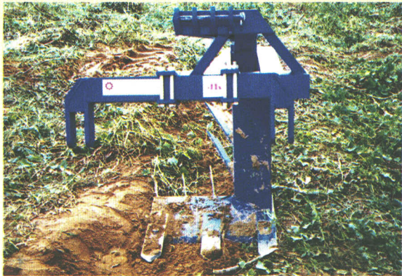
▲ เครื่องชุดหัวมันสำปะหลัง ใช้ติดท้ายรถแทรกเตอร์ ▲
