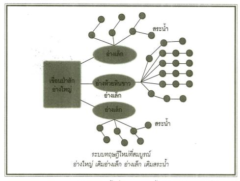
จากภาพ วงกลมเล็ก คือสระน้ำที่เกษตรกรขุดขึ้นตามทฤษฎีใหม่ เมื่อเกิดช่วง ขาดแคลนน้ำในฤดูแล้ง เกษตรกรสามารถสูบน้ำมาใช้ประโยชน์ได้ และหากน้ำในสระน้ำ ไม่เพียงพอก็ขอรับน้ำจากอ่างห้วยหินขาว (อ่างเล็ก) ซึ่งได้ทำระบบส่งน้ำเชื่อมต่อทางท่อ ลงมายังสระน้ำที่ได้ขุดไว้ในแต่ละแปลง ซึ่งจะช่วยให้สามารถมีน้ำใช้ตลอดปี
