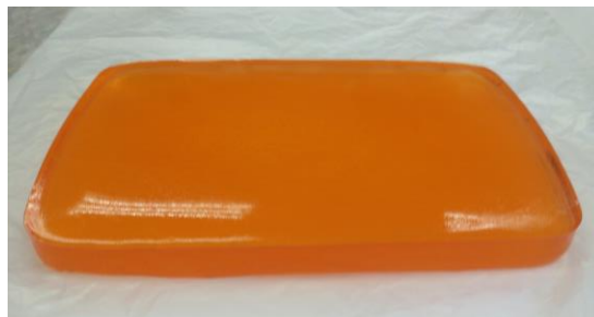
รูปที่ 3.20 ก. การขึ้นรูปเจลในโมลด์พลาสติก ข. เจลหลังจากนำออกจากโมลด์.
