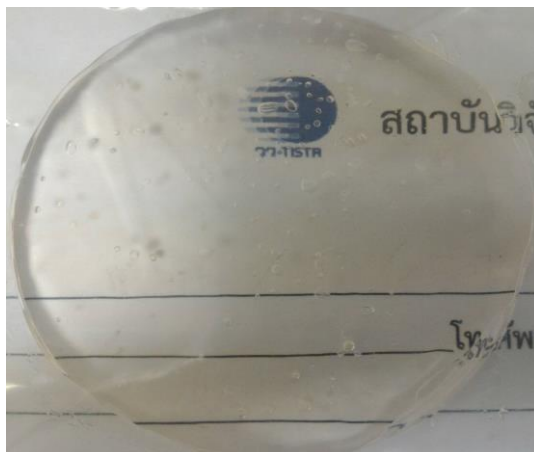
รูปที่ 3.15 สารละลายที่เปลี่ยนรูปเป็นเจล.
