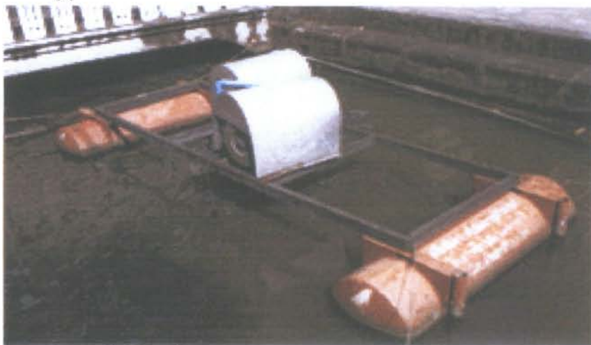
รูปที่ 3.2 เครื่องกลเติมอากาศ ชัยพัฒนาซูปเปอร์ฟองแอร์
