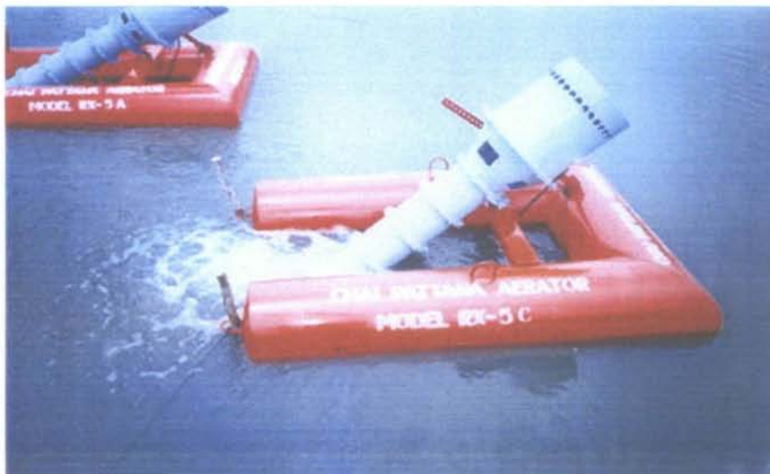
รูปที่ 3.4 เครื่องกลเติมอากาศ ชัยพัฒนาแอร์เจท
