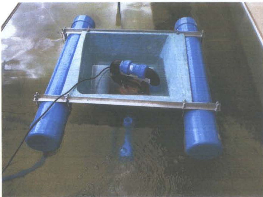
รูปที่ 3.10 การทดลองเดินเครื่องกลเติมอากาศเพื่อเก็บข้อมูล
