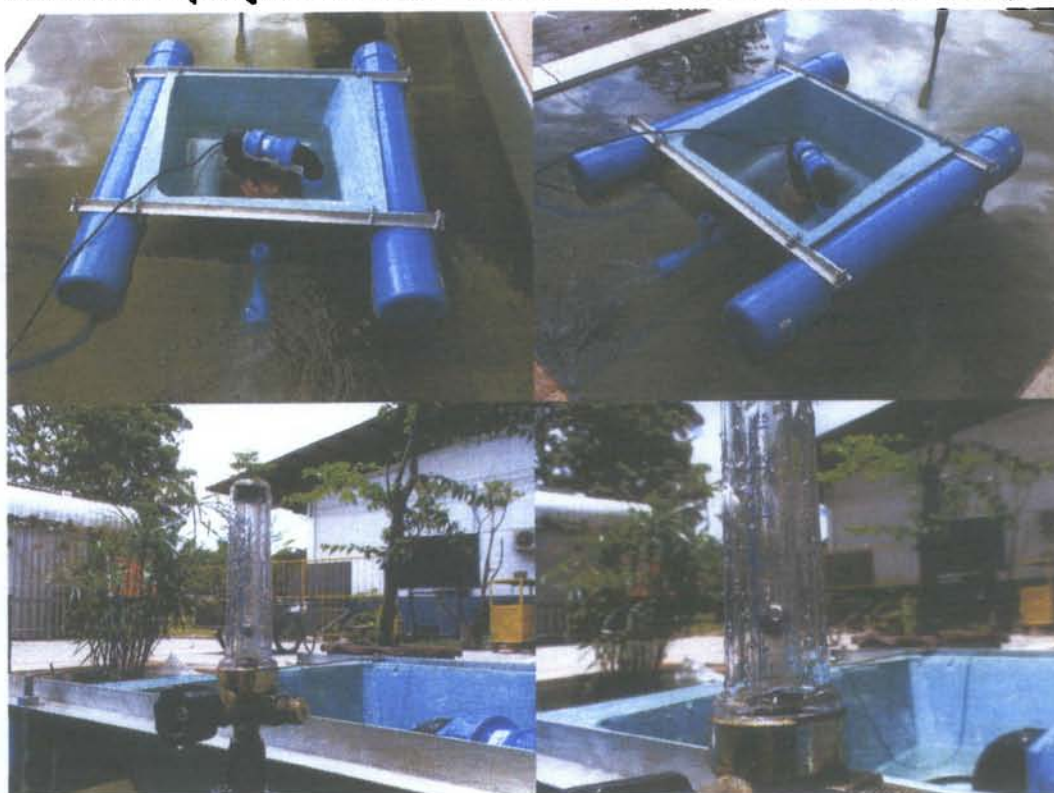
รูปที่ 2.7 การทดลองเครื่องกลเติมอากาศเพื่อหาอัตราการไหลของอากาศ
