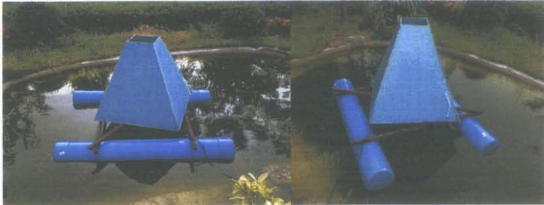
รูปที่ 2.5 ทดสอบการลอยตัวของทุ่นลอย
