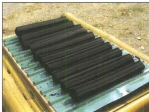
ภาพที่ 8 ถ่านอัดแท่งที่มีส่วนผสมระหว่างผงถ่านบด 4,000 กรัม กับกาวแป้งมันสำปะหลังที่ระดับความเข้มข้น 5 เปอร์เซ็นต์
