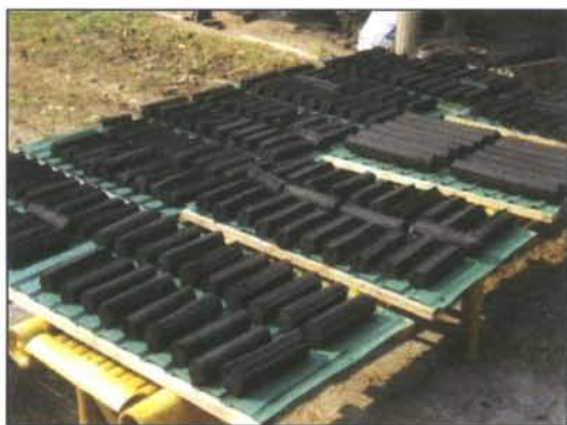
ภาพที่ 3 การเรียงถ่านอัดแท่งจากส่วนผสมต่าง ๆ เพื่อเตรียมนำไปทดสอบ และหาประสิทธิภาพการใช้งาน
