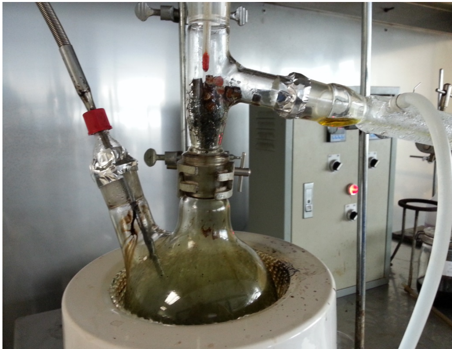
รูปที่ 2.2 ชุดอุปกรณ์กลั่นแบบธรรมดาด้วยสารเร่งปฏิกิริยา.
