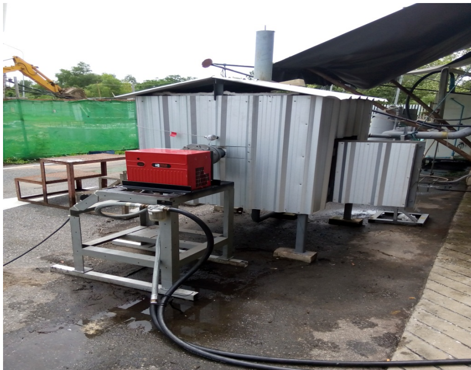
รูปที่ 2.12 ห้องเผาไหม้ต้นแบบพร้อมชุดหัวเผา.
