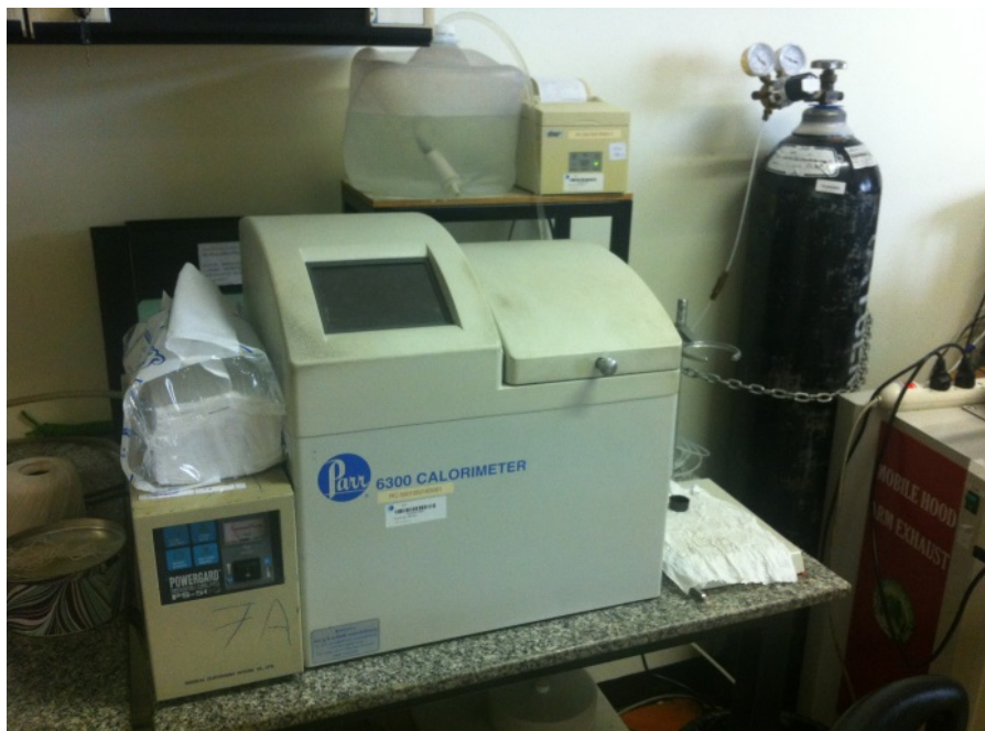
รูปที่ 2.9 เครื่องมือวิเคราะห์หาค่าความร้อน.
