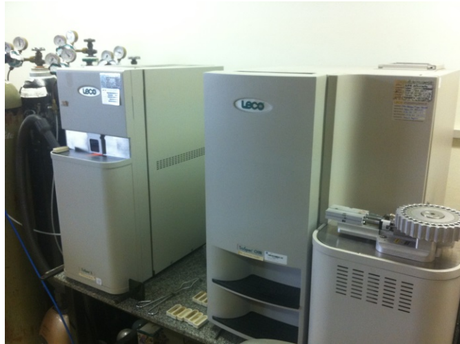
รูปที่ 2.11 เครื่องมือวิเคราะห์ C, H และ N.
