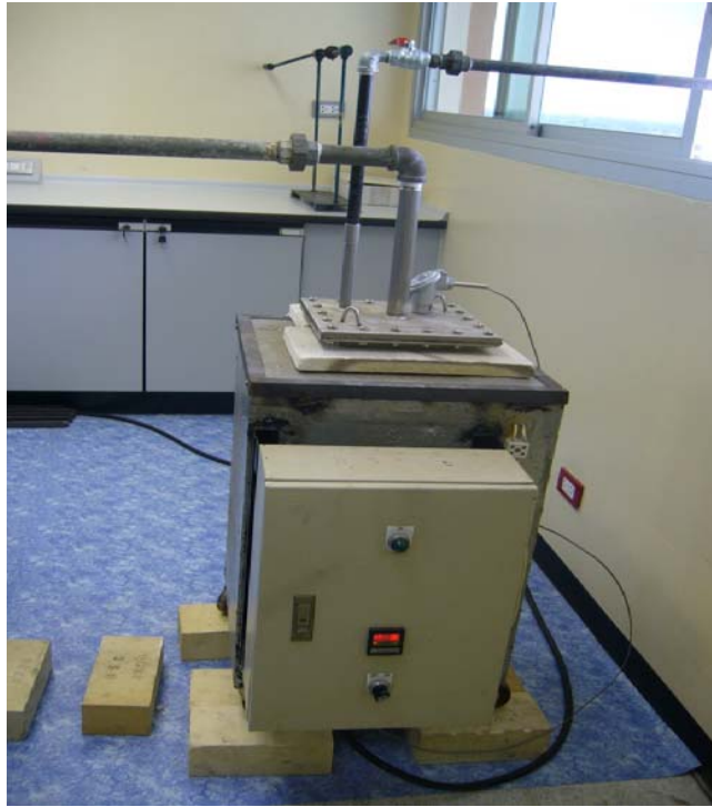
รูปที่ 2.7 อุปกรณ์การกลั่นสลายชีวมวลเป็นน้ำมันดิน.
