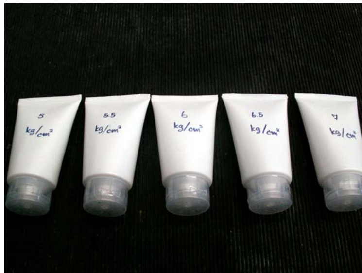
รูปที่ 18. การทดลองผนังและเชื่อมกันหลอดพลาสติกที่มีขนาดหน้ากว้าง 3.5 เซนติเมตร.
