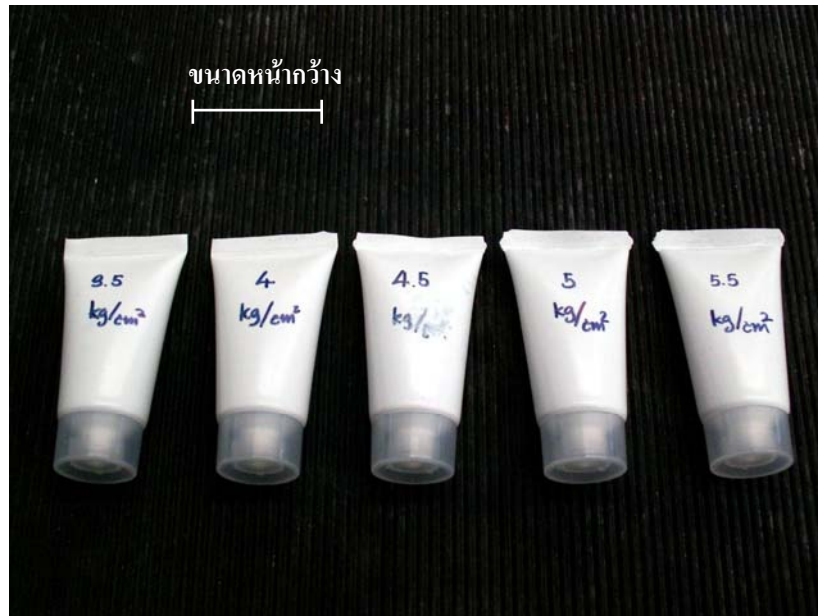
รูปที่ 18. การทดลองผนังและเชื่อมกันหลอดพลาสติกที่มีขนาดหน้ากว้าง 3.5 เซนติเมตร.
