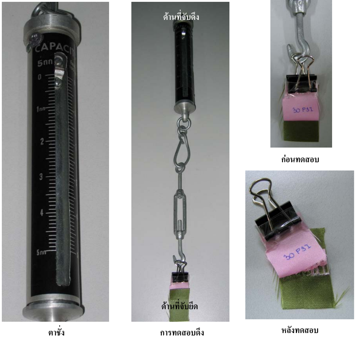
รูปที่ 26. ตาชั่งสำหรับวัดค่าแรงดึง การทดสอบดึงผ้าใยสังเคราะห์ ลักษณะก่อนและหลังการทดสอบวัสดุใยสังเคราะห์.
