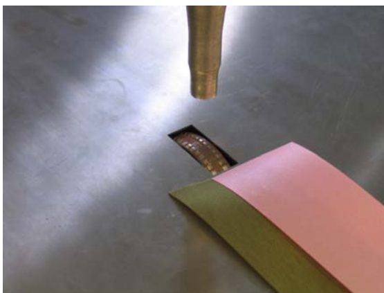
รูปที่ 23. การทดสอบเย็บวัสดุใยสังเคราะห์แบบต่อเนื่อง.
