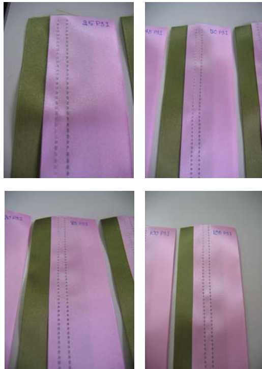
รูปที่ 25. การเย็บวัสดุแบบต่อเนื่องโดยการปรับเปลี่ยนแรงกดที่กระทำต่อใยสังเคราะห์.
