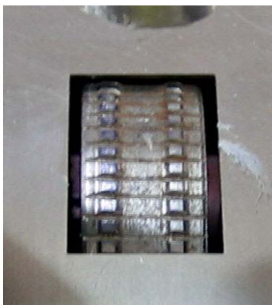
รูปที่ 24. ลวดลายบนล้อยหมุนที่ใช้ในการทดสอบ.
