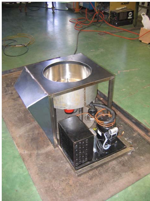
รูปที่ 10. การติดตั้งระบบทำความเย็นสำหรับควบคุมอุณหภูมิ.
