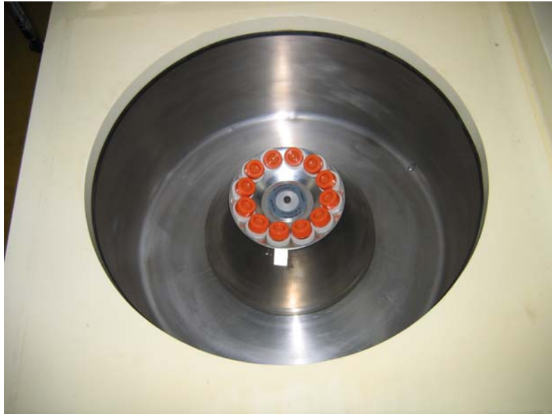
โรเตอร์ขนาดบรรจุหลอดทดลอง 15 มิลลิลิตร จำนวน 12 หลอด.
