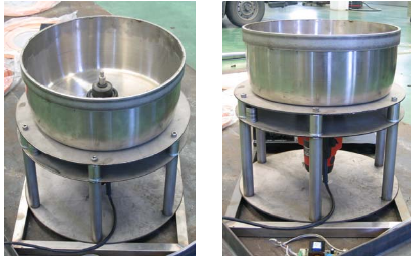
รูปที่ 9. การติดตั้งมอเตอร์ ห้องที่ติดตั้งโรเตอร์ และแกนของโรเตอร์เข้าด้วยกัน.
