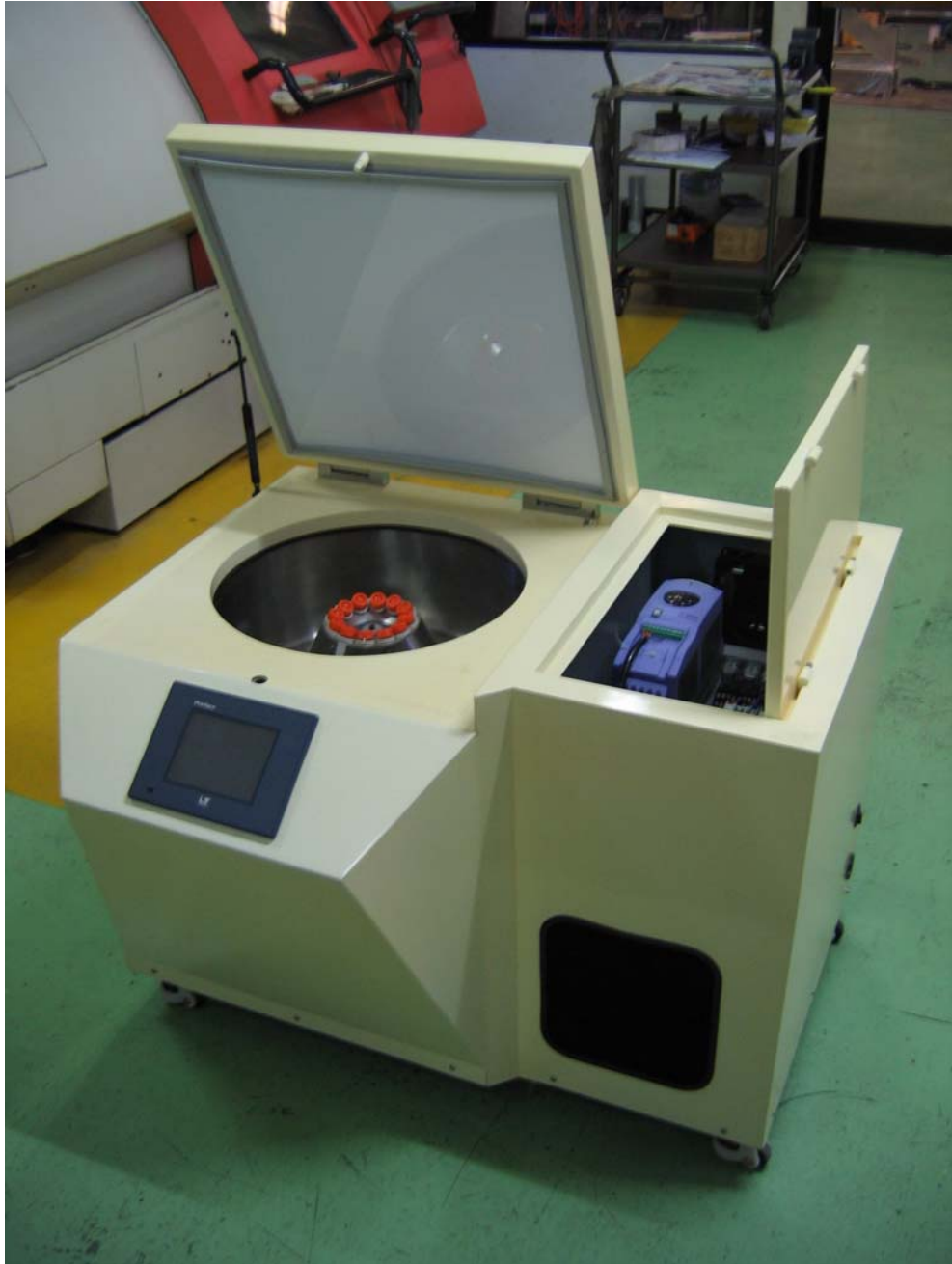
รูปที่ 11. การติดตั้งโรเตอร์, ชุดอุปกรณ์ควบคุมความเร็วรอบ, แผงควบคุม, สวิตช์ และชุดเซนเซอร์ต่างๆ พร้อมทั้งดำเนินการตกแต่งสภาพภายนอกให้มีความสวยงาม.
