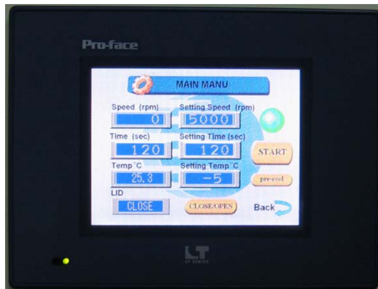
รูปที่ 6. ชุดควบคุมแบบ PLC (Programmable Logic Control) แบบหน้าจอสัมผัส.
