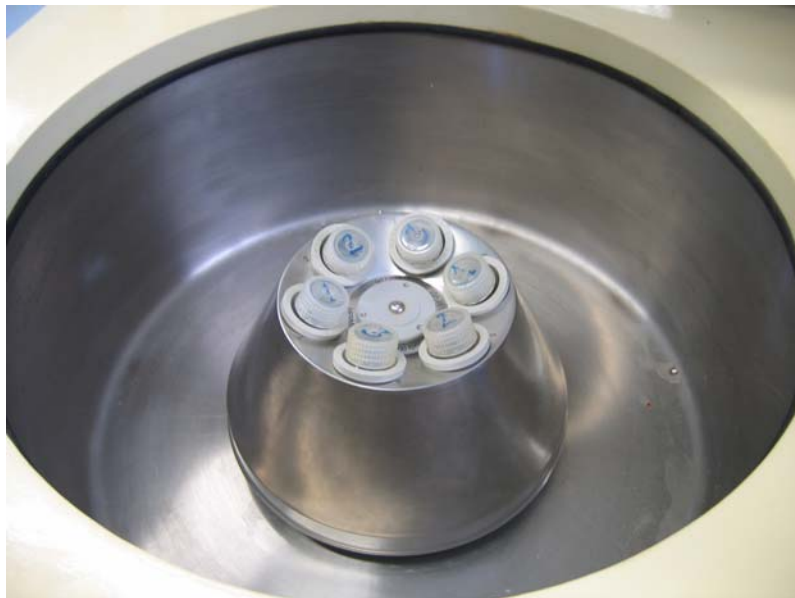
โรเตอร์ขนาดบรรจุหลอดทดลอง 50 มิลลิลิตร จำนวน 6 หลอด
