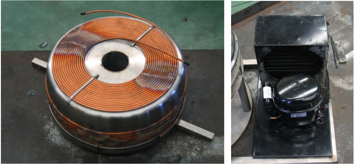
รูปที่ 7. ชุดควบคุมอุณหภูมิภายในห้องที่ติดตั้งโรเตอร์.
