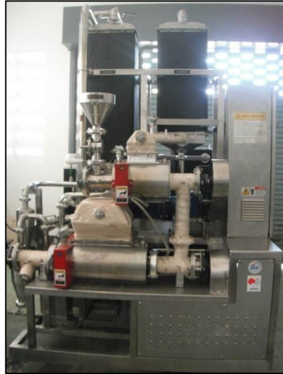
รูปที่ 3.2 เครื่องปฏิกรณ์ไพโรไลซิสแบบสกรูสองขั้นตอน.
