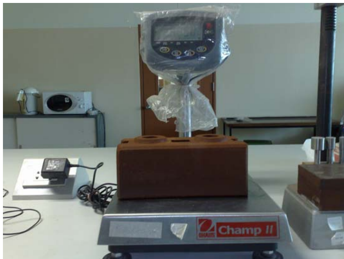
รูปที่ 23. การชั่งน้ำหนักเพื่อหาน้ำหนักบล็อกประสานเมื่อเปียก.
