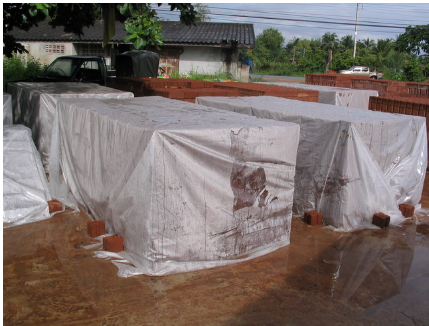
รูปที่ 18. การบ่มบล็อกประสานโดยการคลุมด้วยพลาสติก.
