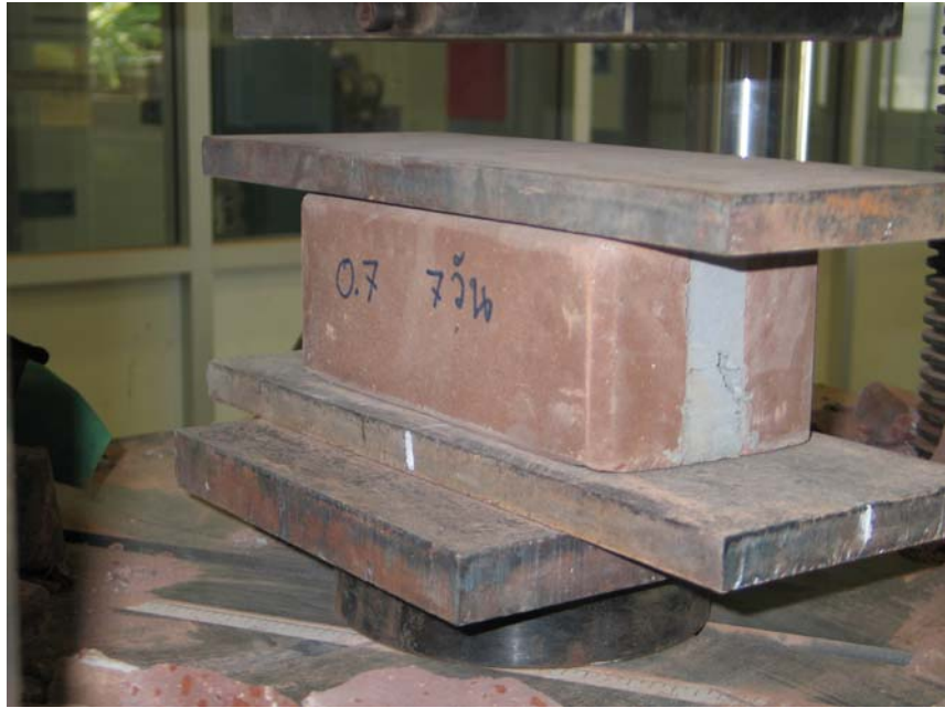
รูปที่ 26 สภาพก้อนตัวอย่างก่อนทำการทดสอบกำลังรับแรงอัด.
