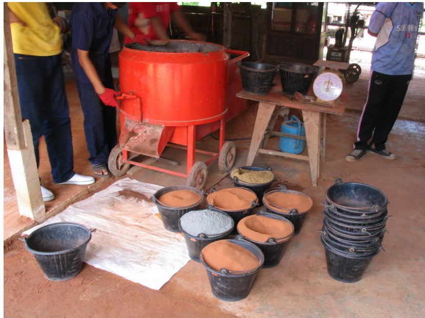
รูปที่ 15. เตรียมส่วนผสมโดยชั่งน้ำหนักเตรียมวัสดุที่แห้งก่อนผสม.
