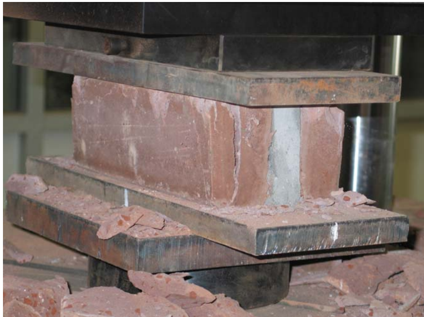
รูปที่ 27. สภาพก้อนตัวอย่างภายหลังการทดสอบกำลังรับแรงอัด.
