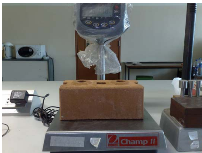
รูปที่ 24. การชั่งน้ำหนักเพื่อหาน้ำหนักบล็อกประสานเมื่อแห้ง.
