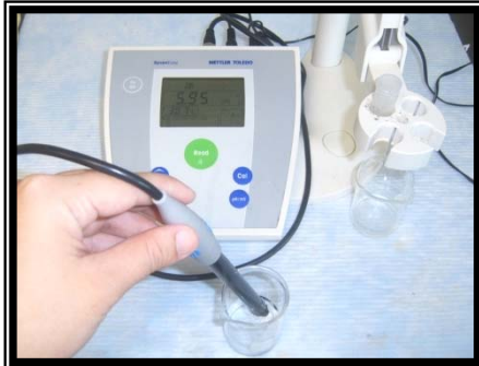
เครื่องวัดความเป็นกรด-เบส (ราคา 36,000-38,000 บาท)
