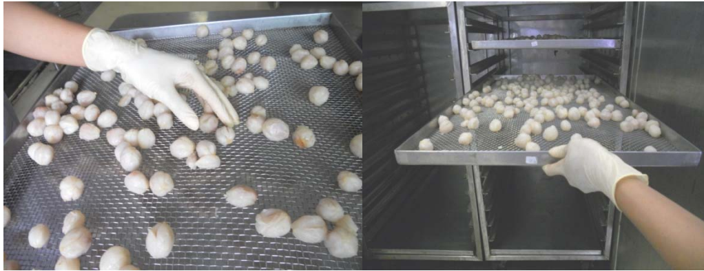
รูปที่ 8.9 อบที่อุณหภูมิประมาณ 50-55 °ซ. เวลาประมาณ 15-18 ชั่วโมง.
