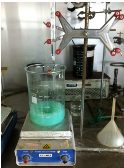
รูปที่ 14. การตกตะกอนด้วยร้อยละ 2.5 ของสารละลายแอมโมเนีย.
