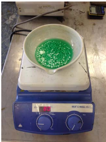
รูปที่ 10. แช่เม็ดอะลูมินาในสารละลายนิกเกิลไนเตรดที่อุณหภูมิ 80 องศาเซลเซียส.
