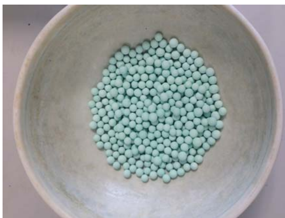
รูปที่ 11. ลักษณะตัวรองรับอะลูมินาที่จุ่มเคลือบนิกเกิลไนเตรดหลังการอบ.
