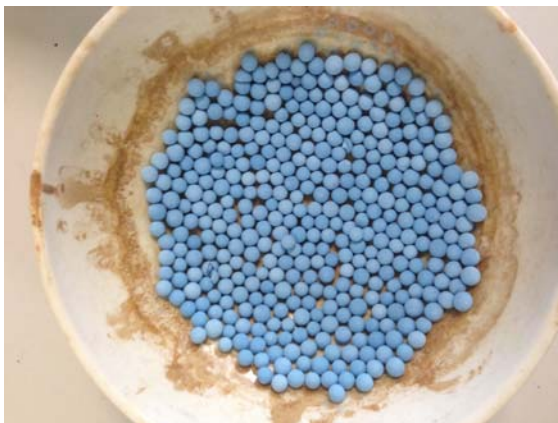
รูปที่ 12. ตัวเร่งปฏิกิริยานิกเกิลบนตัวรองรับอะลูมินาหลังการเผา.
