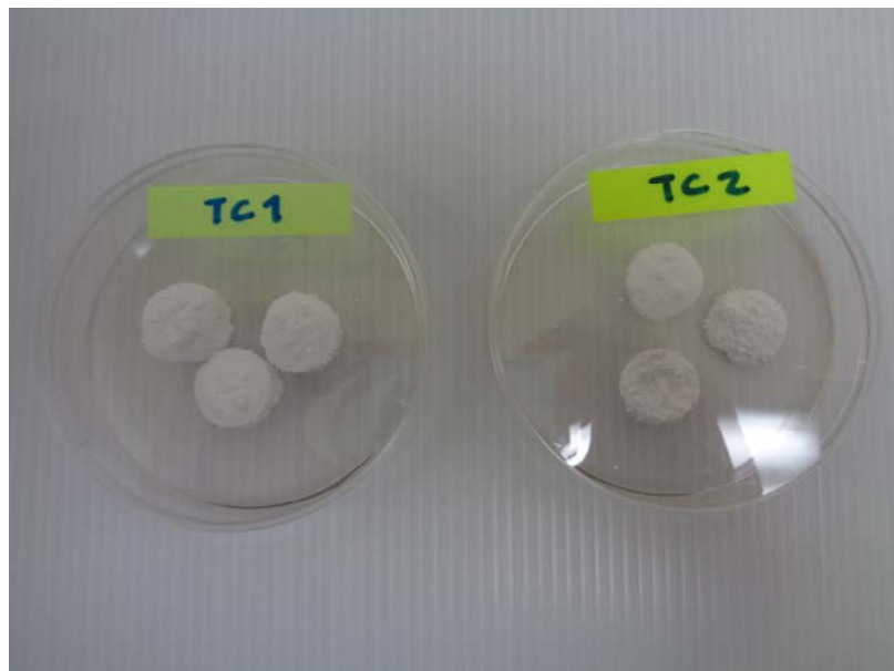
รูปที่ 2. รูปลักษณะของวัสดุทดแทนกระดูกชนิด TC 1 และ TC 2 ที่ใช้ในการทดสอบ.
