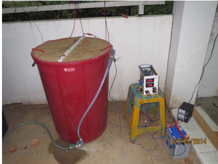
รูปที่ 32. ตัวอย่างการจัดวางอุปกรณ์ในการทดลองบนภาตโคลนขนาด \varnothing 60 \times 86 เซนติเมตร.
