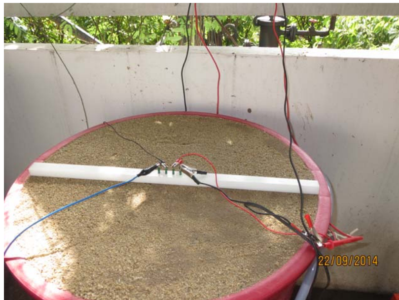
รูปที่ 31. ตัวอย่างการจัดวางขั้วไฟฟ้าบนถาดโคลนขนาด \varnothing 60 \times 86 เซนติเมตร.
