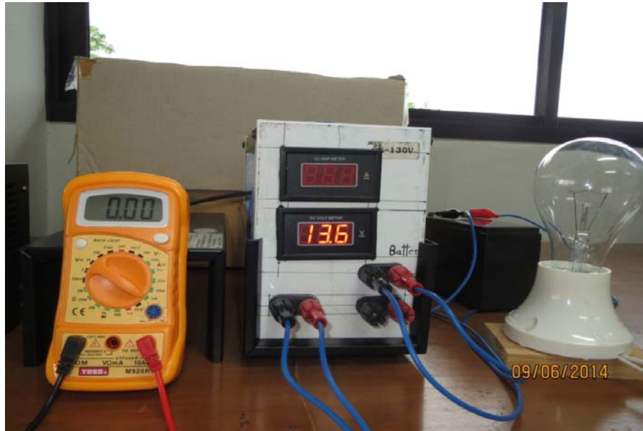
รูปที่ 20. เครื่องสร้างแรงดันไฟฟ้าสูงแบบที่ควบคุมกระแสไฟฟ้าได้เมื่อปรับแรงดันไฟฟ้าต่ำสุด.
