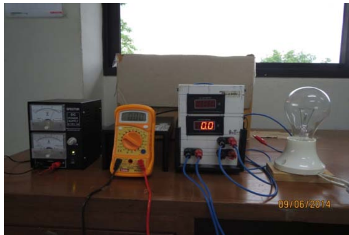
รูปที่ 19. การจัดวางอุปกรณ์ทดสอบเครื่องสร้างแรงดันไฟฟ้าสูงแบบที่ควบคุมกระแสไฟฟ้าได้.
