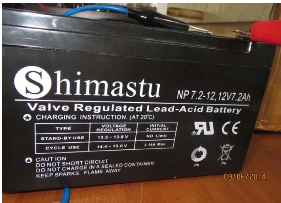
รูปที่ 21. แบตเตอรี่ขนาด 12 โวลต์ ที่ใช้เป็นตัวจ่ายกำลังงานให้เครื่องสร้างแรงดันไฟฟ้าสูงแบบที่ควบคุมกระแสไฟฟ้าได้.
