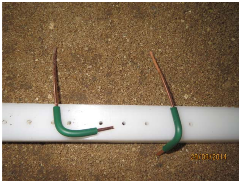
รูปที่ 33. ตัวอย่างหมุดทองแดงที่ใช้ทำเป็นขั้วไฟฟ้าในการทดลองบนภาตโคลน.
