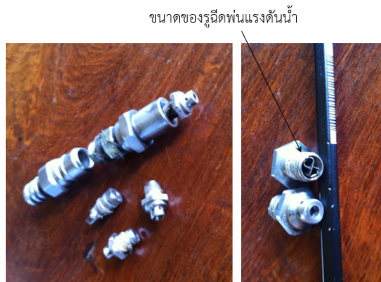
รูปที่ 27. หัวฉีดพ่นแรงดันน้ำสูง.
