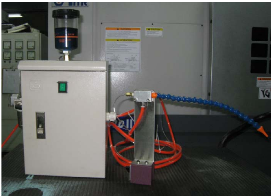
รูปที่ 7. อุปกรณ์หล่อเย็นต้นแบบ 1 หัวฉีด.
