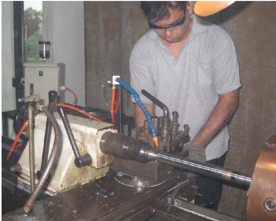
รูปที่ 10. การทดลองด้วยงานกลึงปอกผิว.
