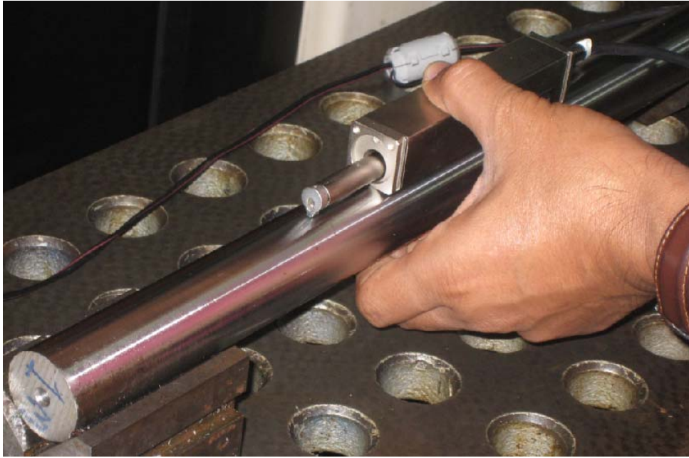
รูปที่ 11. การวัดความหยาบผิวชิ้นงาน.
