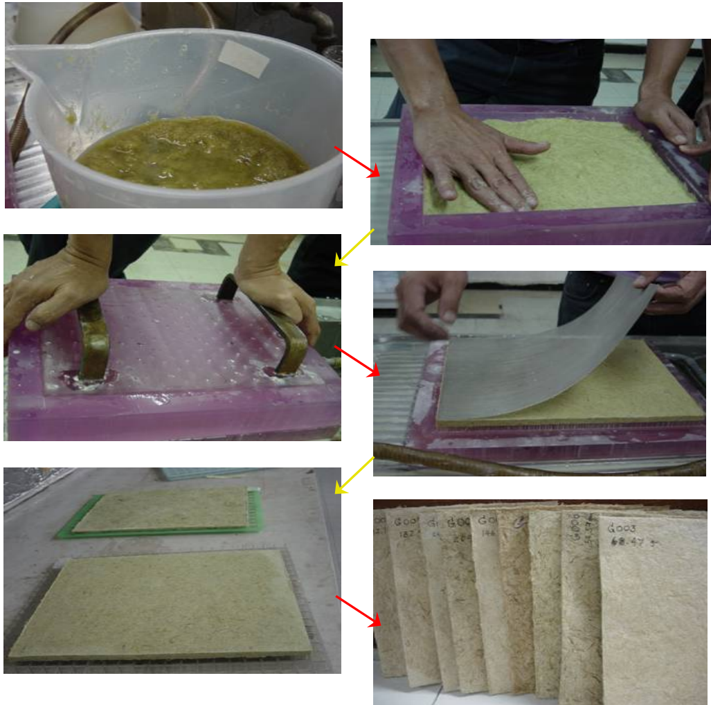
รูปที่ 2.2 ขั้นตอนการขึ้นรูปแผ่นฉนวนจากเยื่อฟางข้าวแบบไม่ใช้ตัวประสาน.
