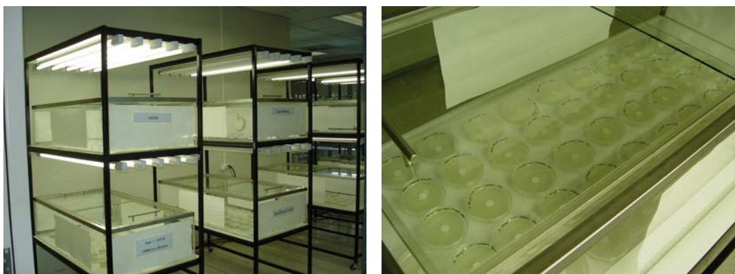
รูปที่ 3. ตู้ควบคุมความชื้น (humidity cabinet).
