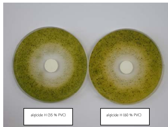
รูปที่ 12. ประสิทธิภาพของสารต้านสาหร่ายที่ป่นภายใต้ความเข้มแสง 6,000 ลักซ์.
