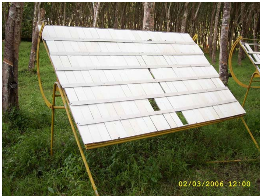
รูปที่ 12. การวางแผนทดสอบสี ณ สวนยางพารา จ.ตรัง.
