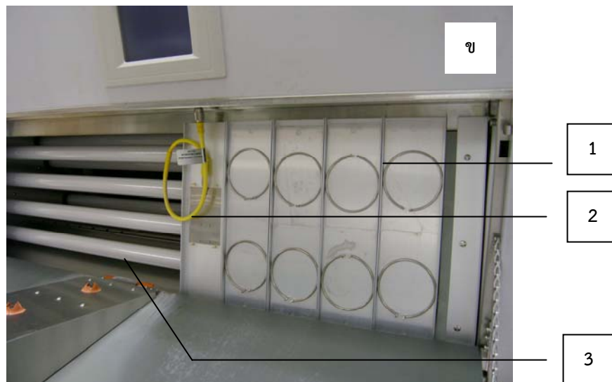
รูปที่ 6. เครื่องเร่งสภาวะแผ่นทดสอบ.
