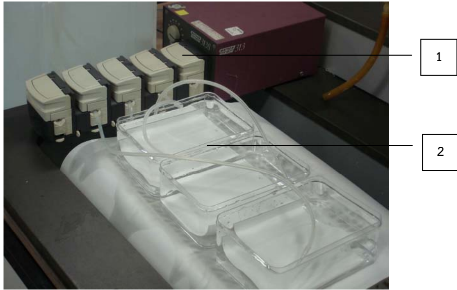
รูปที่ 4. การแช่แผ่นทดสอบในน้ำไหล.
