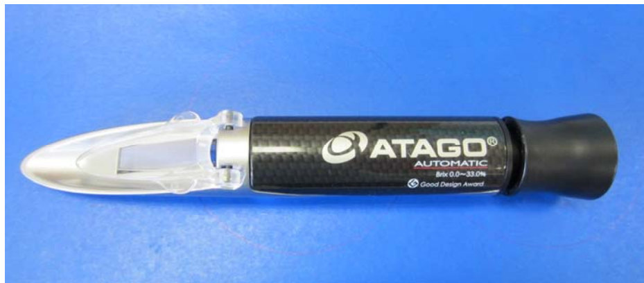
รูปที่ 1. เครื่องวัดปริมาณน้ำตาล (Master Refractometer).
