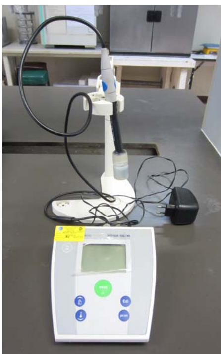
รูปที่ 2. เครื่องวัดความเป็นกรด-เบส (pH meter).
