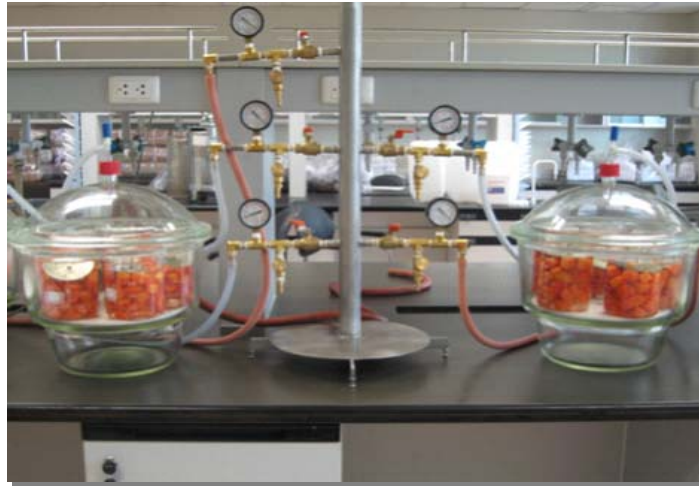
รูปที่ 8. การแช่อิมม็อบแห้งภายใต้ระบบสุญญากาศ (Vacuum Infusion).
