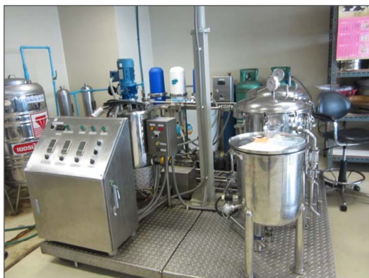
รูปที่ 3. เครื่องแช่อบผลไม้ภายใต้ระบบสุญญากาศ (Vacuum).
