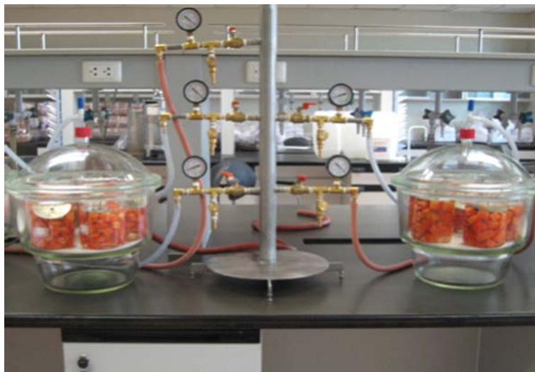
รูปที่ 2. การแช่อบแห้งภายใต้ระบบสุญญากาศ (Vacuum Infusion).
