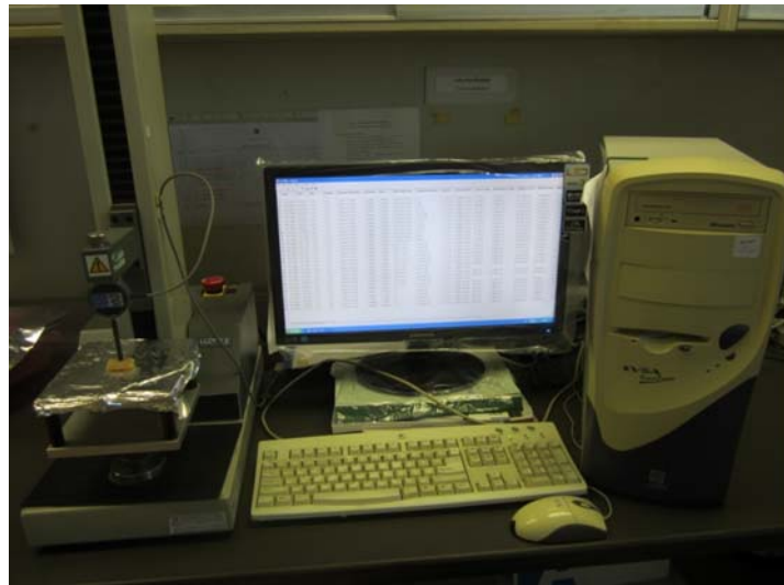
รูปที่ 7. เครื่องวิเคราะห์ลักษณะเนื้อสัมผัสอาหาร (Lloyd Food Texture Analyzer Model TA 500).
