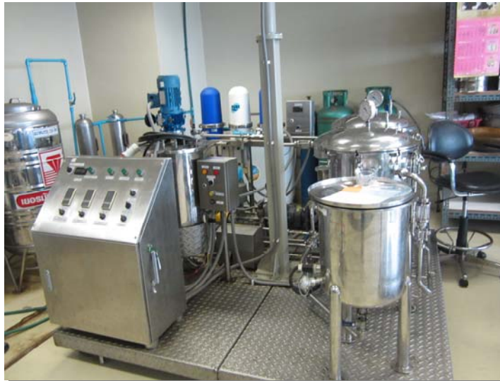
รูปที่ 19. การแช่อิ่มเงาะน้ำเสาวรภายใต้ระบบสุญญากาศ (Vacuum).
