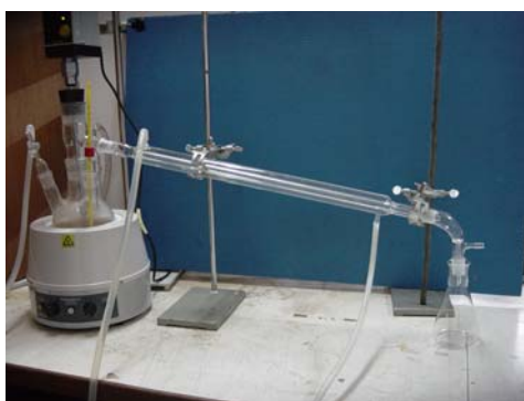
รูปที่ 2. การติดตั้งเครื่องมืออุปกรณ์สำหรับขั้นตอนการทำ Esterification และ Polycondensation
