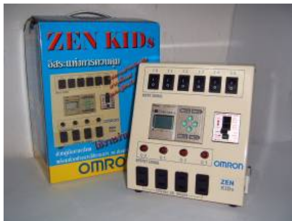
รูปที่ ก 5. เครื่องควบคุมระบบการทำงาน (PLC).
