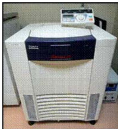
รูปที่ ง-32 เครื่องปั่นเหวี่ยงความเร็วสูงระบบทำความเย็น รุ่น Suprema 25.
