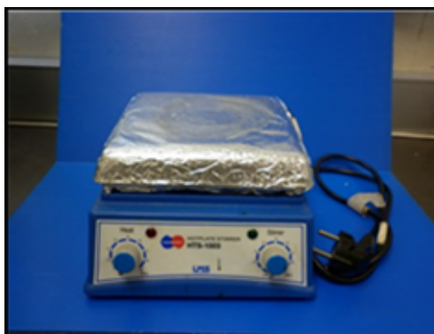
รูปที่ 22 Hot plate stirrer รุ่น HTS – 1003.
