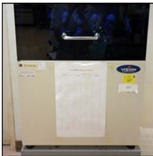
รูปที่ ง - 26 เครื่องเขย่าแบบควบคุมอุณหภูมิ (Shaking incubator) รุ่น VS – 8480SPN.
