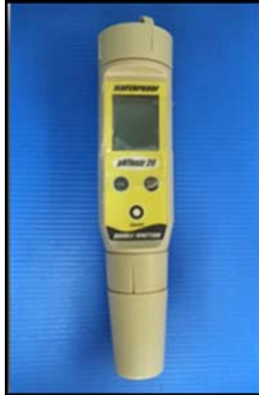
รูปที่ ง - 29 เครื่องวัดความเป็นกรด - เบส (pH meter) รุ่น 1539931.
