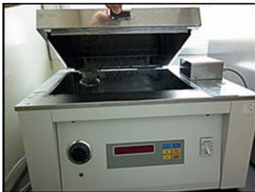
รูปที่ ง - 25 อ่างควบคุมอุณหภูมิ (Water bath) รุ่น series 2000.
