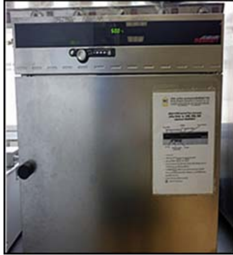
รูปที่ ง - 23 ตู้อบลมร้อน (Hot air oven) ยี่ห้อ memmert รุ่น UNB.
