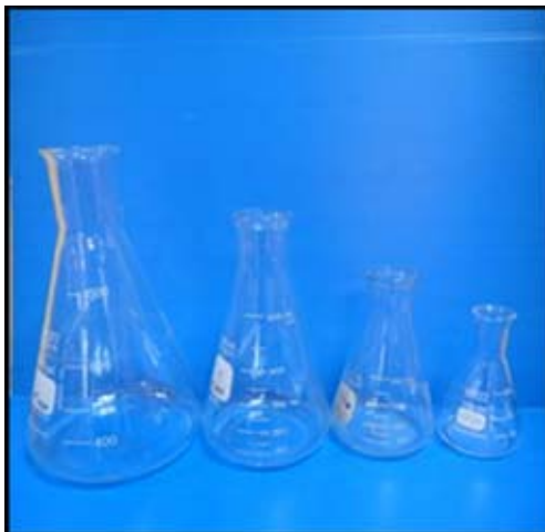
รูปที่ ง - 5 ขวดรูปชมพู่ (Erlenmeyer flask).
