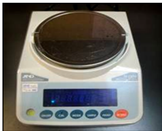
รูปที่ ง - 30 เครื่องชั่งน้ำหนัก 2 ตำแหน่ง ยี่ห้อ FX - 2000i.
