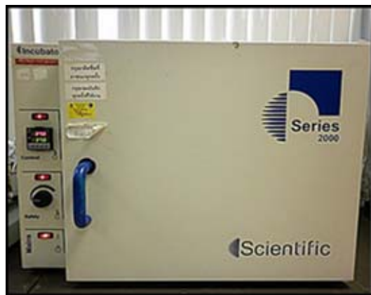
รูปที่ ง - 24 ตู้อบเชื้อแบบควบคุมอุณหภูมิ (Incubator) ยี่ห้อ Scientific รุ่น Series 2000.
