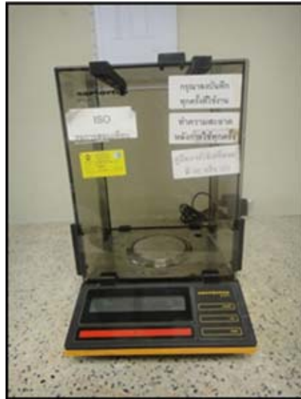
รูปที่ ง-31 เครื่องชั่งน้ำหนัก 4 ตำแหน่ง ยี่ห้อ Sartorius A 200S.
