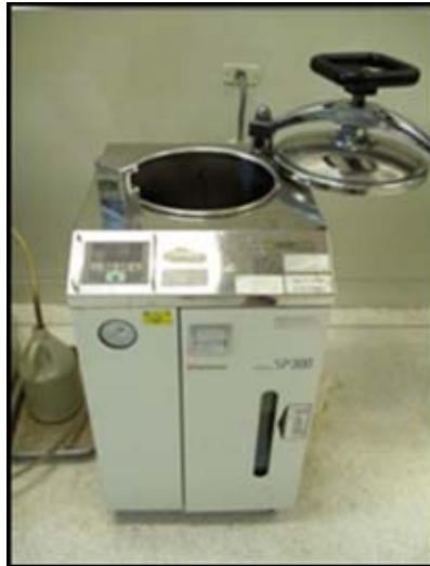
รูปที่ ง - 27 หม้อนึ่งความดันไอน้ำ (Autoclave) ยี่ห้อ Yamato รุ่น SP 300.
