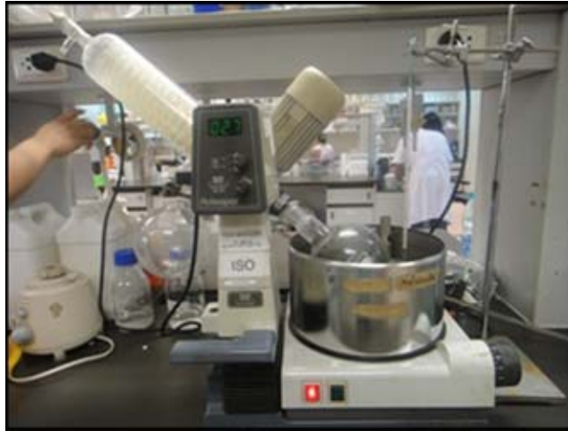
รูปที่ ง-35 เครื่องกลั่น ระเหยแห้ง (Evaporator).
