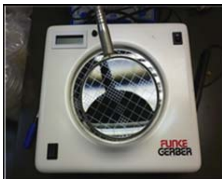
รูปที่ ง - 28 เครื่องนับจำนวนโคโลนี (Colony counter) รุ่น 8502-2092.
