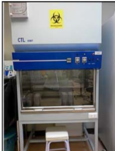
รูปที่ ง - 20 ตู้เป็ยเชื้อ (Laminar air flow) รุ่น CTL 101.
