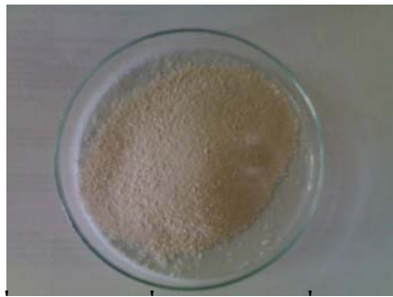
รูปที่ 30. ตะกรันที่ผ่านการกำจัดสิ่งเจือปนและเผา.
