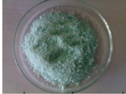
รูปที่ 31. ตะกรันที่ผ่านการกำจัดสิ่งเจือปนที่เผาแล้วหลอมกับโซเดียมไฮดรอกไซด์.
