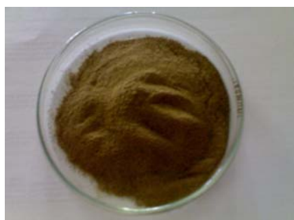
รูปที่ 28. ตะกรันที่เป็นวัตถุดิบเริ่มต้นก่อนกำจัดสิ่งเจือปน.
