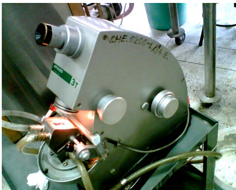
รูปที่ ๑1. เครื่องวัดค่าดัชนีหักเหของแสงของของเหลว (Refractometer).
