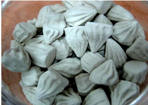
รูปที่ 6. ลักษณะของดินขาวที่มีสารประกอบของแคลเซียมคาร์บอเนต.
