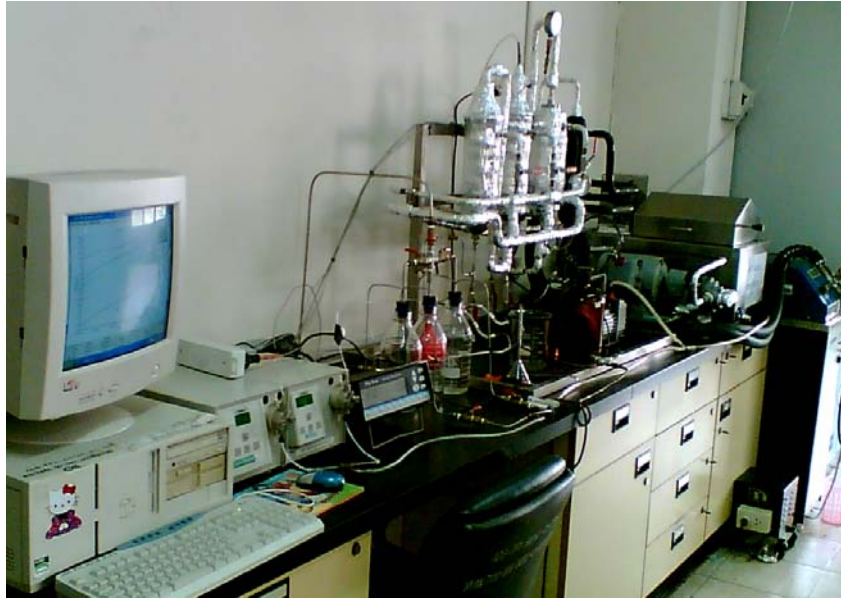
รูปที่ 38. ชุดทดสอบสารดูดซับในกระบวนการผลิตเอทานอลไร้น้ำ.
