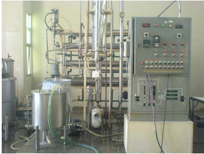
รูปที่ 8. เครื่องฆ่าเชื้อน้ำผลไม้และเครื่องตีมว.
