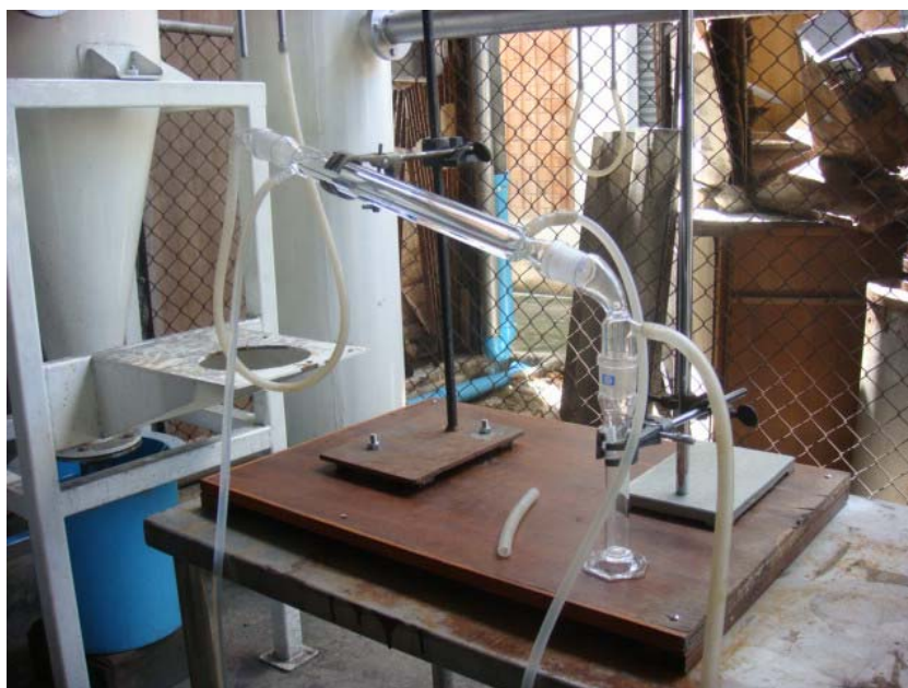
รูปที่ 2.12 เครื่องมือวัดปริมาณน้ำมันดิน.
