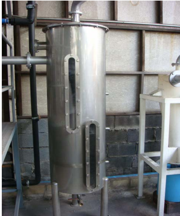
รูปที่ 2.7 ชุดล้างกักเก็บน้ำมันดินและน้ำส้มควันไม้.
