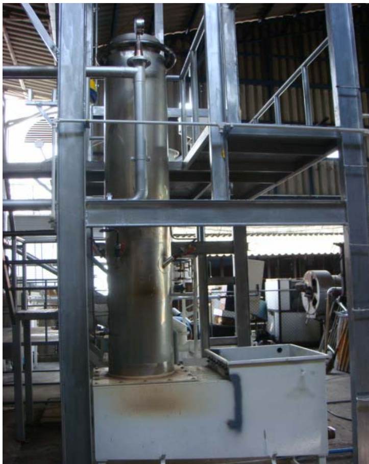
รูปที่ 2.1 เตาปฏิกรณ์แก๊สซิฟิเคชันเปิดแบบไหลลง.
