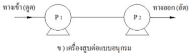
รูปที่ 61. เครื่องสูบล้อต่อแบบอนุกรมและแบบขนาน.
