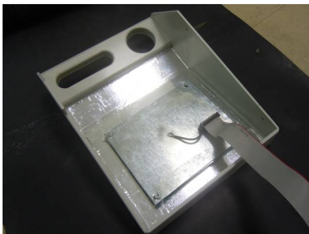
รูปที่ 3.46. การติดตั้งแผ่น ground plate หลังแผ่นวงจรไฟฟ้า (panel PCB).
