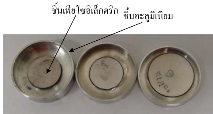
รูปที่ 3.13. หัววัดอะลูมิเนียมที่ติดชั้นเพียโซอิเล็กทริกเซรามิกความถี่ 1 เมกะเฮิรตซ์.
