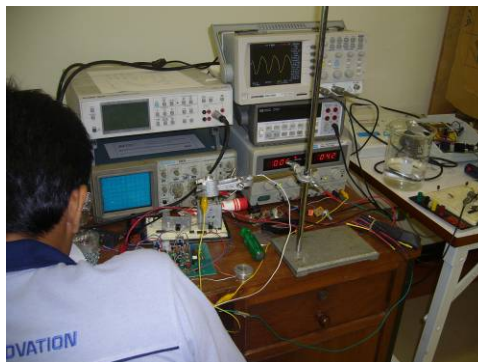
รูปที่ 3.40. การทดสอบชุดหัวขนาด 3 เมกะเฮิร์ตซ์กับวงจรไฟฟ้า.
