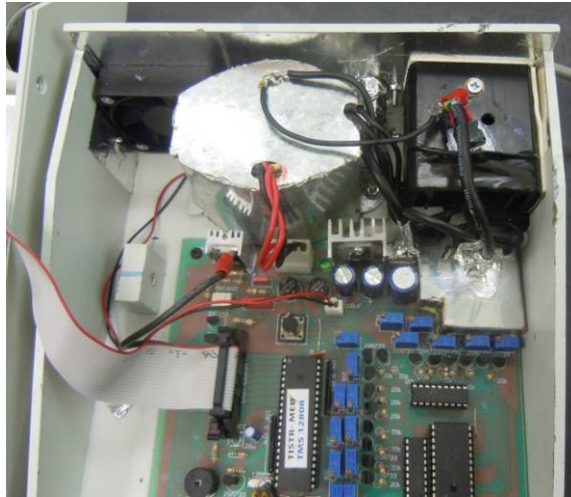
รูปที่ 3.59 การตำแหน่ง heat sink และ ทรานซิสเตอร์ที่ย้ายใหม่ในเครื่อง A.
