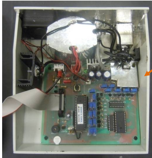
รูปที่ 3.56. ทำฝาสังกะสีครอบภาคจับสัญญาณไฟฟ้าภายในเครื่อง.
