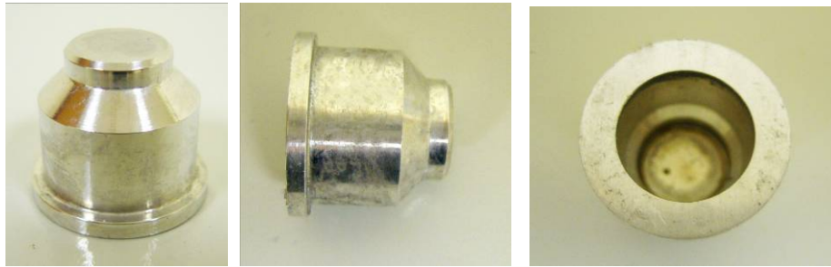
รูปที่ 3.14. การประกอบชั้นเพียโซอิเล็กทริก(PZT) กับหัววัดอะลูมิเนียมความถี่ 3 เมกะเฮิรตซ์.
