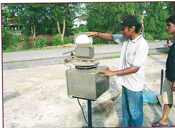
รูปที่ 17. การทดสอบเครื่องหว่านอาหารกึ่งอัตโนมัติต้นแบบ ณ ลานคอนกรีต.
