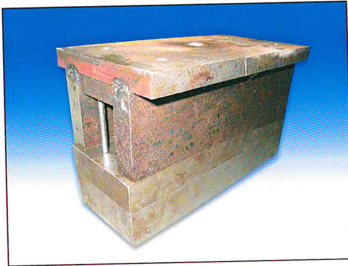
รูปที่ 15. แม่พิมพ์ฉีดสกรูป้อนอาหารกุ้ง.
