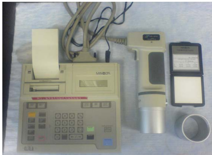
เครื่องวัดสี (Chroma Meter) ยี่ห้อ MINOLTA รุ่น CR 310
