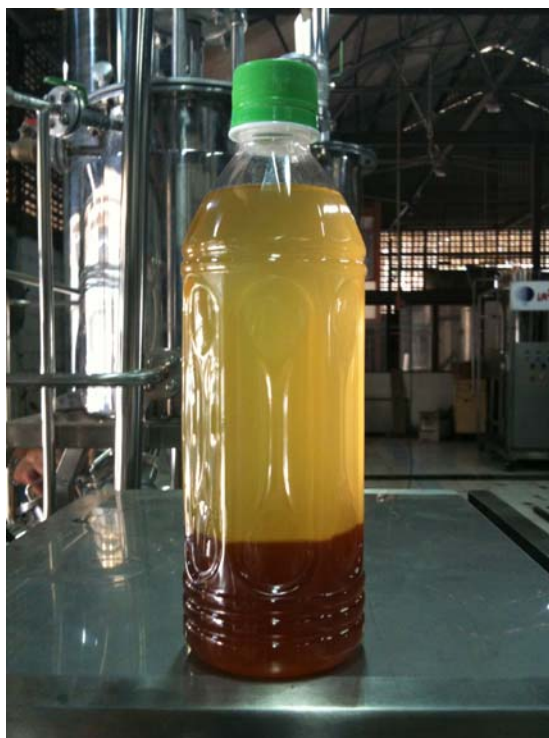
รูปที่ 19. การแยกชั้นระหว่างไบโอดีเซลและกลีเซอริน ที่ได้จากการเครื่องต้นแบบผลิตไบโอดีเซลจากน้ำมันสุญดำ.
