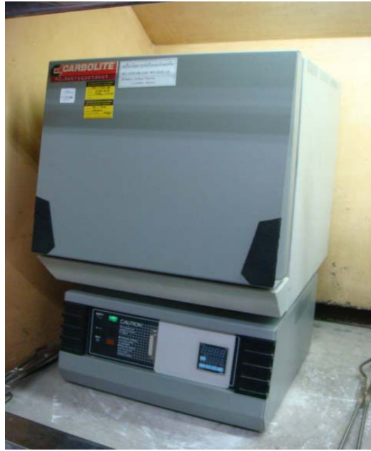
รูปที่ 3.7. เครื่องวัดสารระเหยและจับได้.
