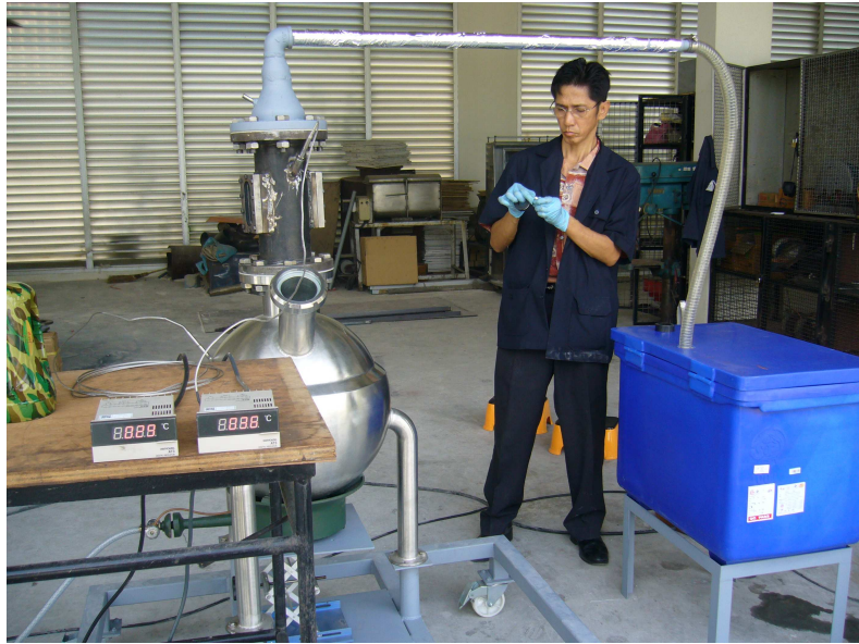
รูปที่ 2.16. การติดตั้งอุปกรณ์วัดอุณหภูมิ.
