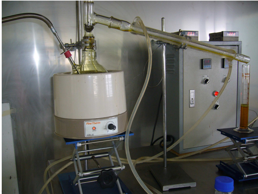
รูปที่ 2.9. ชุดอุปกรณ์การกลั่นแบบธรรมดาในระดับห้องปฏิบัติการ.
