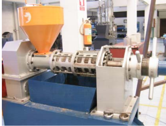
รูปที่ 5. เครื่องสกัดน้ำมันสุบุดำแบบสกรู (Screw press).
