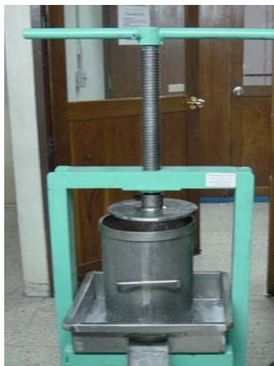
รูปที่ 4. เครื่องสกัดน้ำมันสบู่ดำแบบไฮดรอลิก (Hydraulic press).
