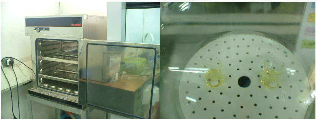
รูปที่ 18. ตู้อบความร้อนและตัวอย่างการเก็บตัวอย่างน้ำมันในเดซิเคเตอร์.
