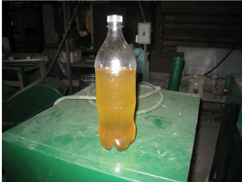
รูปที่ 14. น้ำมันस्पุน้ำที่ได้จากการสกัดด้วยไฮดรอลิก.
