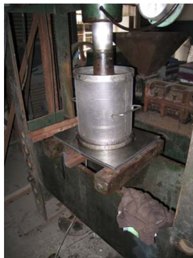
รูปที่ 4. เครื่องสกัดน้ำมันสบู่ดำแบบไฮดรอลิก (Hydraulic press).
