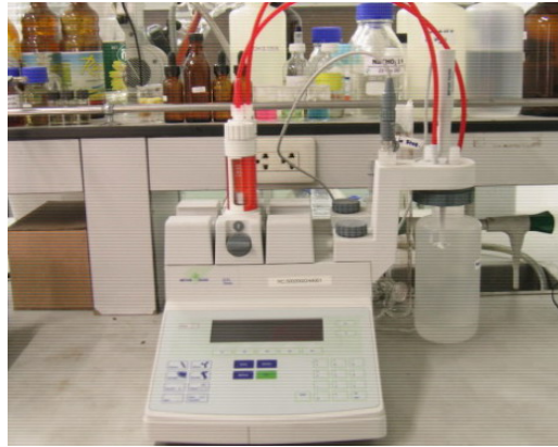
รูปที่ 15. เครื่องไทเทรตแบบอัตโนมัติ (Automation Titrator).
