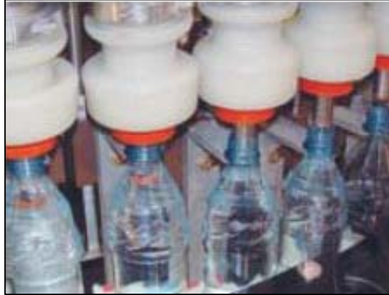
รูปที่ 3. เทคโนโลยีชุดจับคอขวดแบบ neck support.
