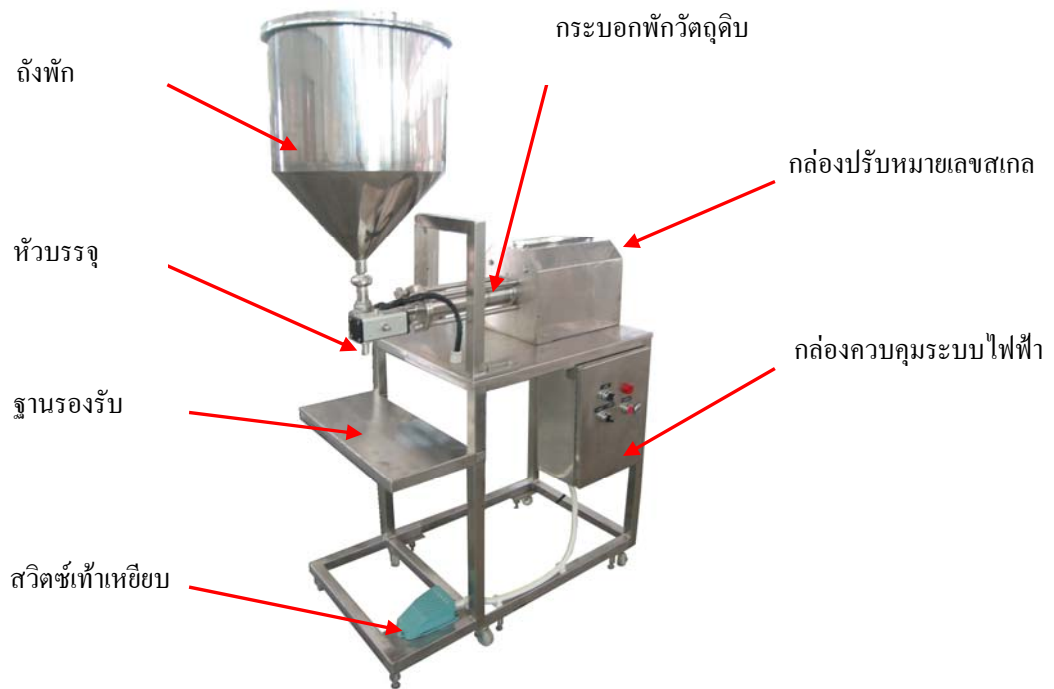
รูปที่ 11. ส่วนประกอบของเครื่องต้นแบบสำหรับบรรจุขอสปริงรส.
