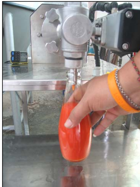
รูปที่ 6. การทดสอบหาปริมาณการบรรจุของเครื่องต้นแบบบรรจุซอสปรุงรส.
