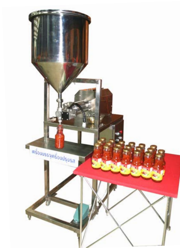
รูปที่ 7. เครื่องต้นแบบสำหรับบรรจุซอสปรุงรส.
