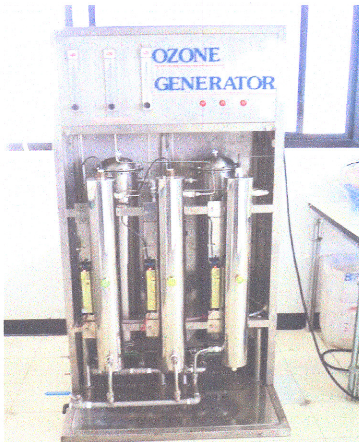
รูปที่ 2. เครื่องผลิตโอโซนที่ใช้ในการบำบัดน้ำเสียจากกระบวนการย้อมสีรีแอกทีฟ.
