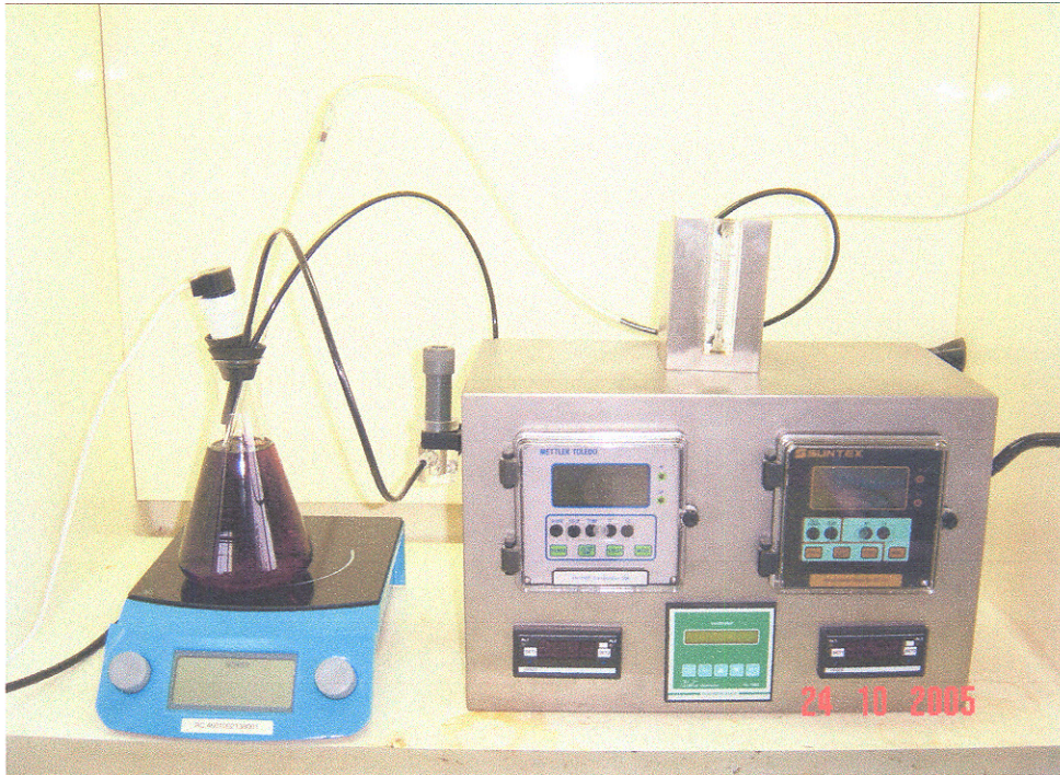
รูปที่ 33. รูปชุดทดสอบการใช้โอโซนบำบัดน้ำเสียฟอกย้อม.
