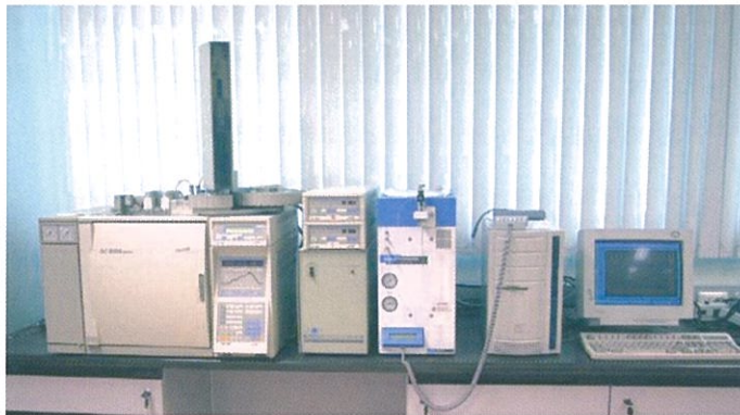
เครื่องแก๊สโครมาโทกราฟี (Gas Chromatograph, GC)
