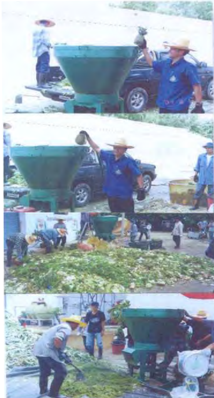
รูปที่ 6. การทดสอบเครื่องสับย่อยกับวัสดุคืบต่างชนิด. (บน) การทดสอบสับย่อยสับประรด ทุเรียนทั้งลูก (ล่าง) เครื่องกำลังสับย่อยเศษผักสดอย่างต่อเนื่อง
