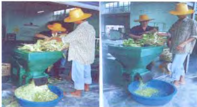
รูปที่ 12. การสร้างและทดสอบเครื่องสับย่อยขนาด 2 แรงม้า. (บน) การผลิตเครื่องสับย่อยขนาดเส้นผ่าศูนย์กลาง 30 ซม. ใช้มอเตอร์ไฟฟ้า 2 แรงม้าเป็นต้นกำลัง (ล่าง) การทดสอบสับย่อยซังข้าวโพดและเศษผัก
