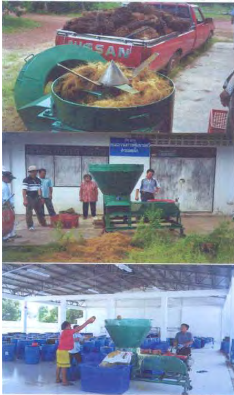
รูปที่ 11. การทดลองสับย่อยทลายปาล์ม สับปะรด ภูเก็ต (บน, กลาง) การทดลองสับย่อยทลายปาล์ม ที่ อ.ท่าตะโก จ.ชุมพร (ล่าง) สับย่อยสับปะรดทั้งลูกแบบต่อเนื่องที่โรงงานผลิตปุ๋ยปลา
