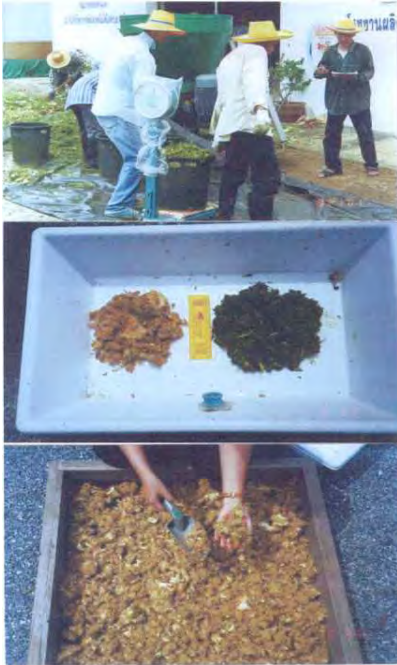
รูปที่ 7. การทดสอบเพื่อหาอัตราการสับย่อย. (บน) การทดสอบเพื่อหาอัตราการสับย่อย (กลาง, ล่าง) เปลือกทุเรียนและเศษผักเมื่อถูกสับย่อยแล้ว
