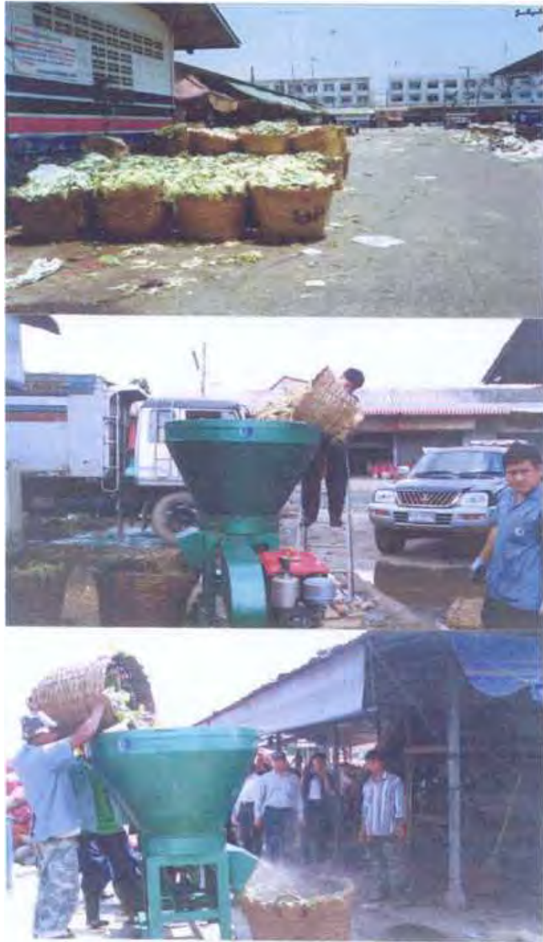
รูปที่ 10. การทดลองสับย่อยผักสด-ขยะอินทรีย์. (บน) เศษผักสดที่ตลาดสี่มุมเมือง (กลาง) ทดลองสับขยะอินทรีย์ (ล่าง) สับย่อยซังข้าวโพด
