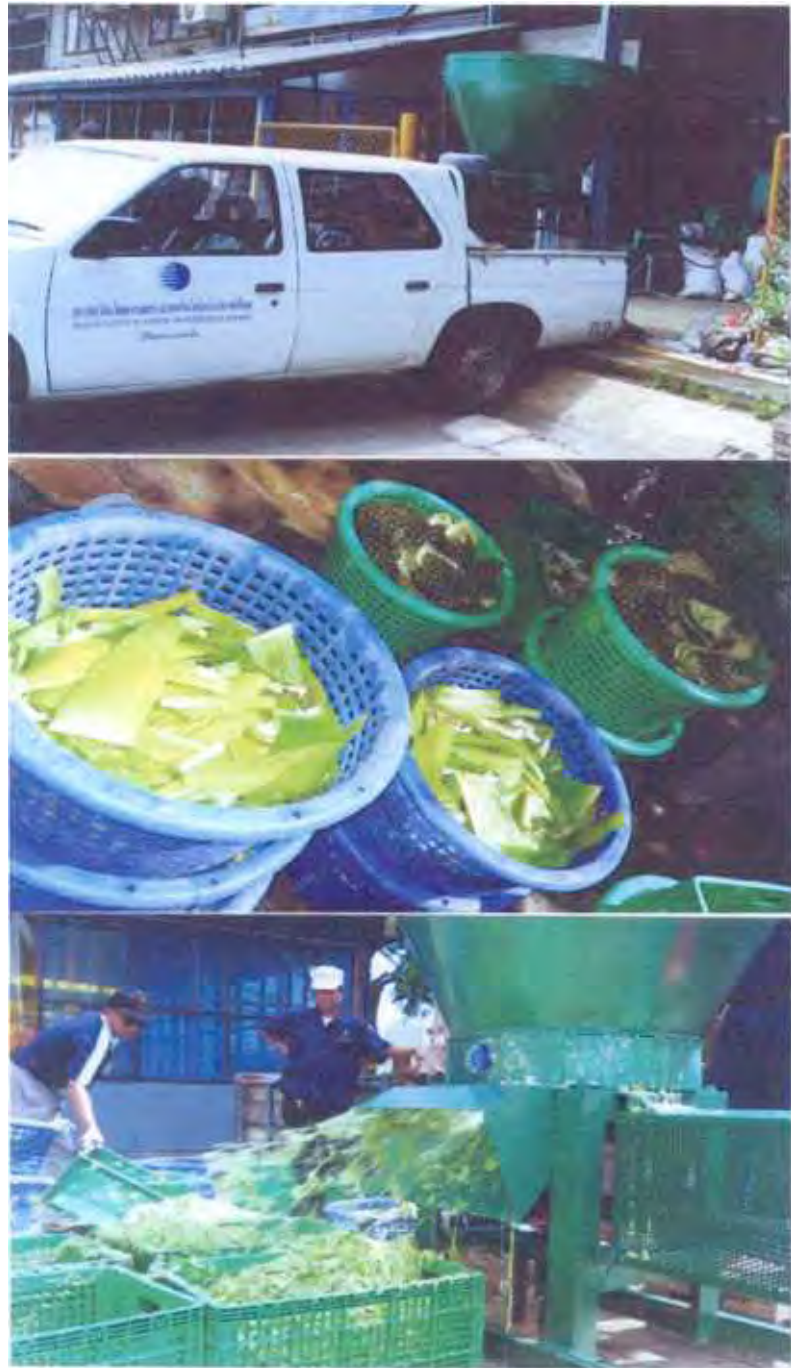
รูปที่ 8. การเคลื่อนย้ายเครื่องไปทดสอบ. (บน) การเคลื่อนย้ายเครื่อง (กลาง, ล่าง) ทดลองสับย่อยวัสดุดิบ (เศษ) เปลือกสับประด/วุ้นหางกระเซ้
