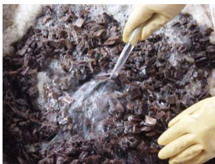
รูปที่ 2.12 ล้างเยื่อหลังต้มด้วยน้ำสะอาดจนหมดค้าง.
