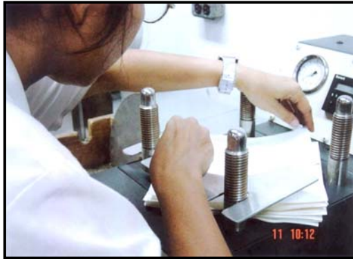
รูปที่ 2.26 เรียงแผ่นเยื่อบนเครื่อง Press เพื่อรีดน้ำออก. รูปที่ 2.27 ตากแผ่นเยื่อบนเครื่องตากเยื่อ.
