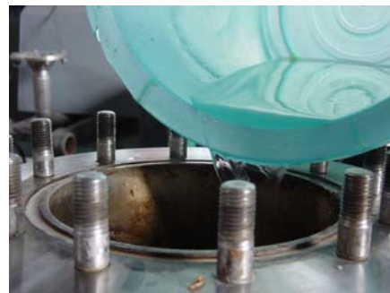
รูปที่ 2.10 เทสารละลายใส่ใน autoclave.
