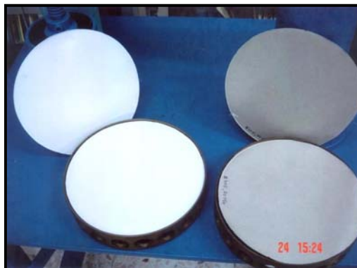
รูปที่ 2.29 แผ่นทดสอบเยื่อชนิดฟอกจางสี (ซ้าย) และชนิดไม่ฟอก (ขวา).
