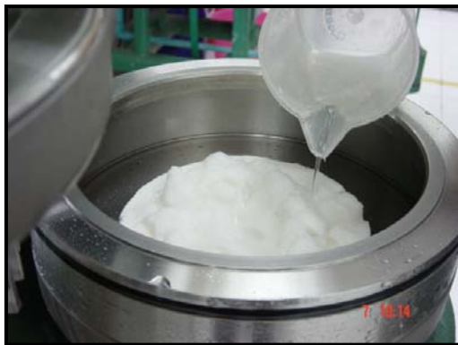
รูปที่ 2.22 เยื่อฟอกก่อนบด.
