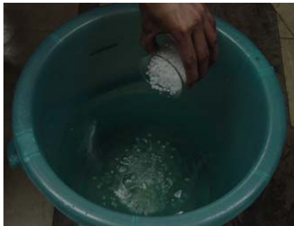
รูปที่ 2.9 ละลายสารโซเดียมไฮดรอกไซด์ในน้ำ.
