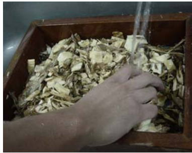
รูปที่ 2.6 ล้างไม้สบู่ออกจากน้ำเพื่อขจัดสิ่งปนเปื้อน.
