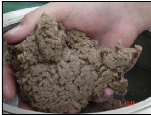
รูปที่ 2.20 เยื่อไม้ฟอกก่อนบด.
