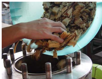
รูปที่ 2.8 เทขึ้นไม้ใส่ Rotary autoclave.
