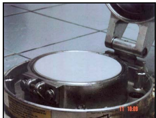
รูปที่ 2.25 แผ่นเยื่อบนตะแกรงเครื่องทำแผ่น.
