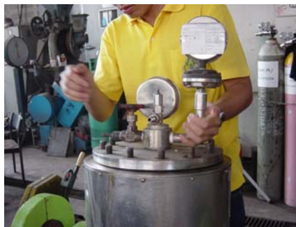
รูปที่ 2.11 ปิดฝา autoclave ให้แน่น.
