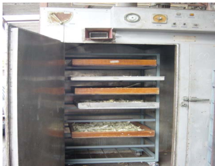
รูปที่ 2.5 อบหรือผึ่งชิ้นไม้ให้แห้ง.
