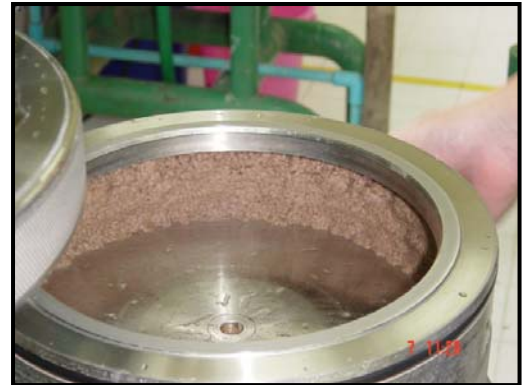
รูปที่ 2.21 เยื่อไม้ฟอกหลังบด.
