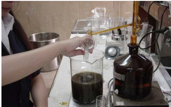
รูปที่ 2.16 วิเคราะห์หาค่าแคปปานัมเบอร์.
