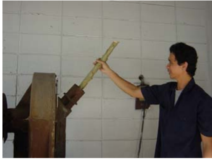
รูปที่ 2.3 สับท่อนไม้สนูปดำด้วยเครื่องสับชิ้น.
