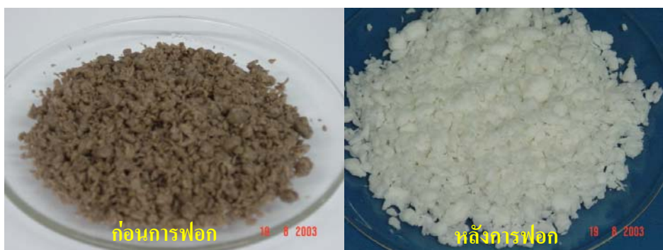
รูปที่ 2.18 การเปรียบเทียบเยื่อก่อนและหลังการฟอกจากสี.
