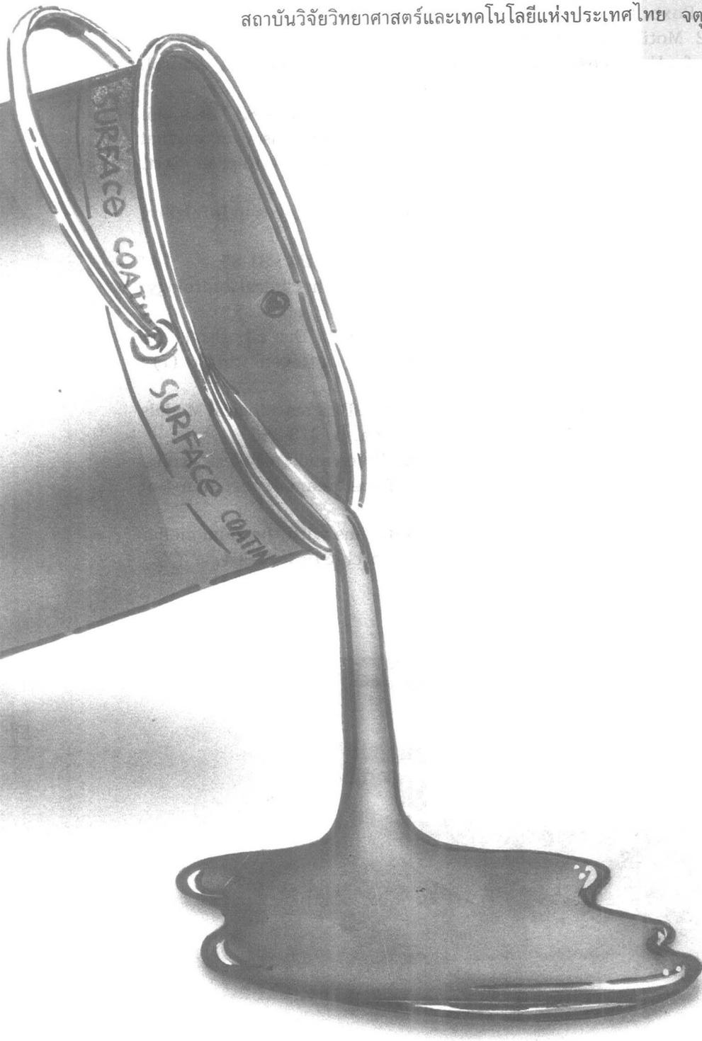
**วัสดุเคลือบผิว (surface coating)** มีประโยชน์ในการป้องกันการผุกร่อน ทำให้เกิดความสวยงามแก่ผลิตภัณฑ์ และใช้เป็นสัญลักษณ์ได้ด้วย ตัวอย่างเช่น วารนิช แล็กเกอร์ และสารประกอบฟอสเฟต.
