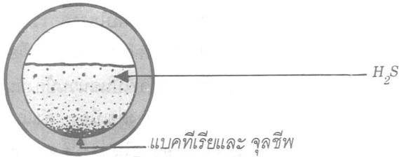
ข. ซัลไฟด์ในของเหลวถ่ายเทมาสู่อากาศและออกสู่บรรยากาศในท่อ ในรูปของแก๊สไฮโดรเจน
